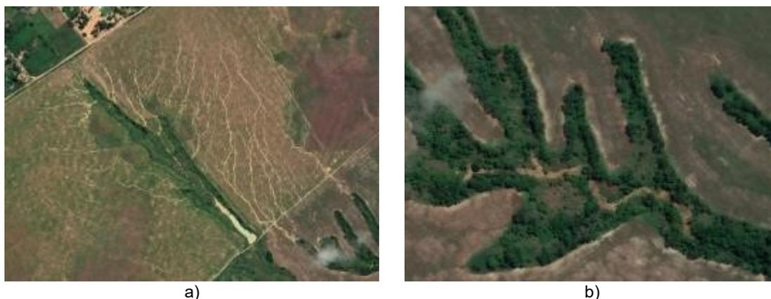
Figure 34. a) Aspect de la formation de rigoles d'érosion dans les cultures annuelles. b) Aspect d'un chenal fluvial avec dépôt de sédiments, en aval de la même zone de la figure (a) (3°01'08.62" S 47°23'58.46" O). Source : Image Digital Globe, *truecolor*, de 06/05/2019.
