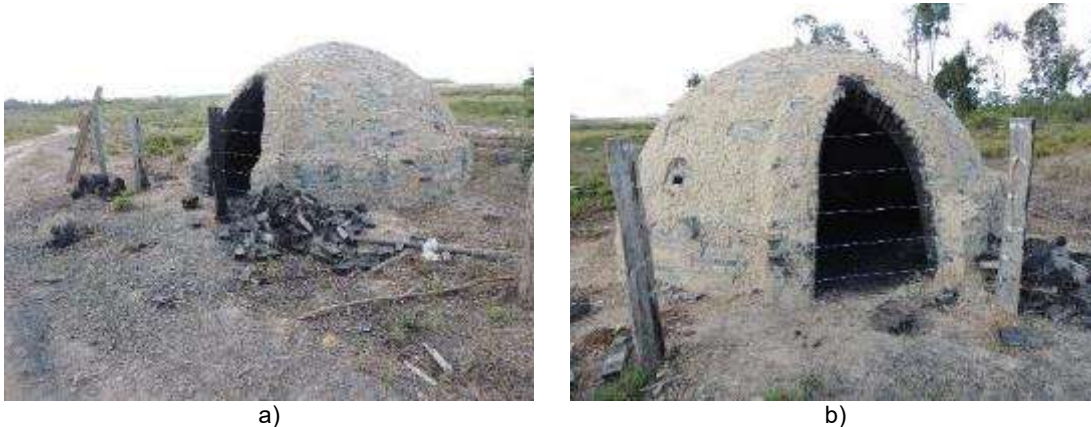
Figure 32. Four artisanal pour la production de charbon de bois (désactivé). Photos : R. Osis (2017).
