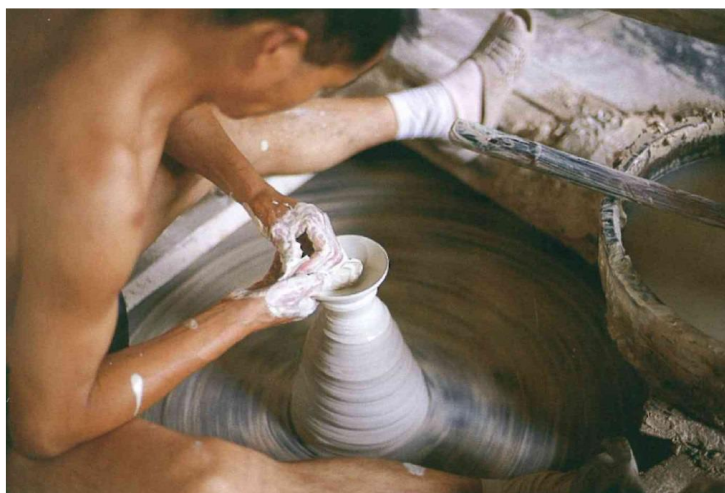
Figure B10 : Utilisation d'une estèque pour calibrer la courbe des parois du bol et la taille de son ouverture, Jingdezhen. Photographie : M. Bai (Bai 2005).
