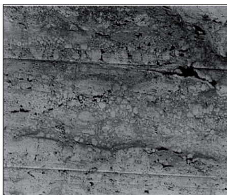
Figure A.27. «Lithoclast travertine » (Guo et Riding, 1998).
