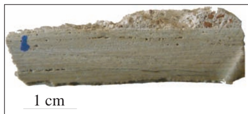
Figure B.91. Echantillon de travertin montrant le faciès C3 (état 5) de la salle T6 des thermes.
