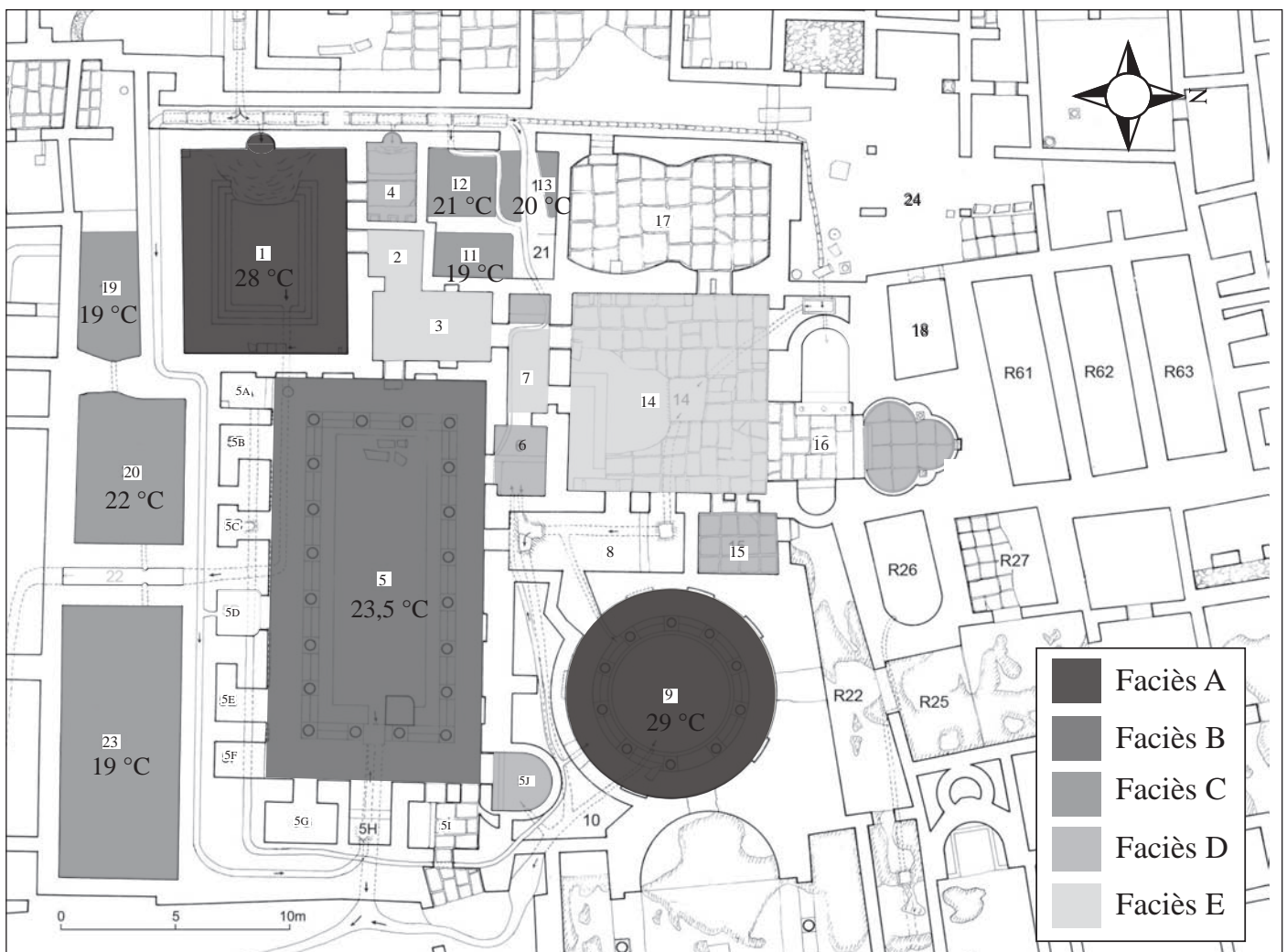
Figure B.76. Répartition spatiale des faciès des travertins anthropiques dans les salles thermales de Jebel Oust et estimation des températures de dépôt associées.
