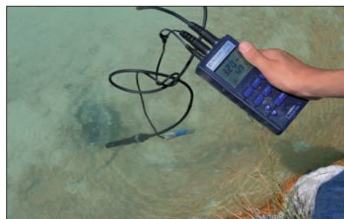
Figure A.61. Sonde multiparamétrique de mesure de la température et du pH des eaux.
