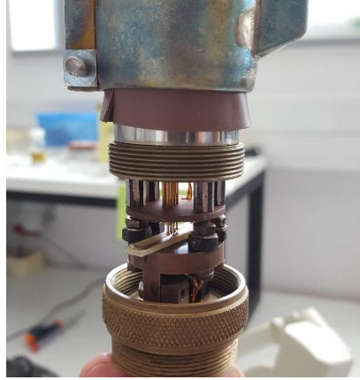
Figure 2.10: Présentation du dispositif expérimental de la mesure 4 points. La distance de deux pointes contiguës est de 1 mm.
