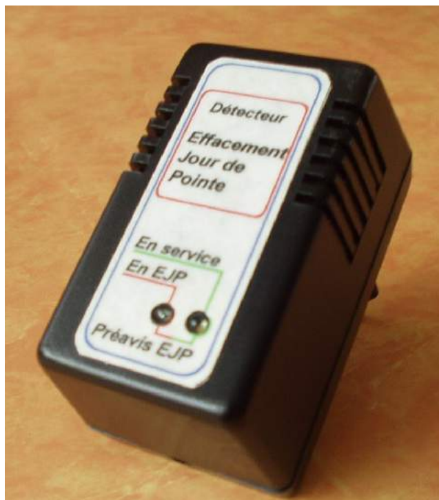
Fig. 15 — Le détecteur Effacement jour de pointe prévient le matin même pour les 22 jours en tarif EJP (Source : M. Benoit, 1998) 1
