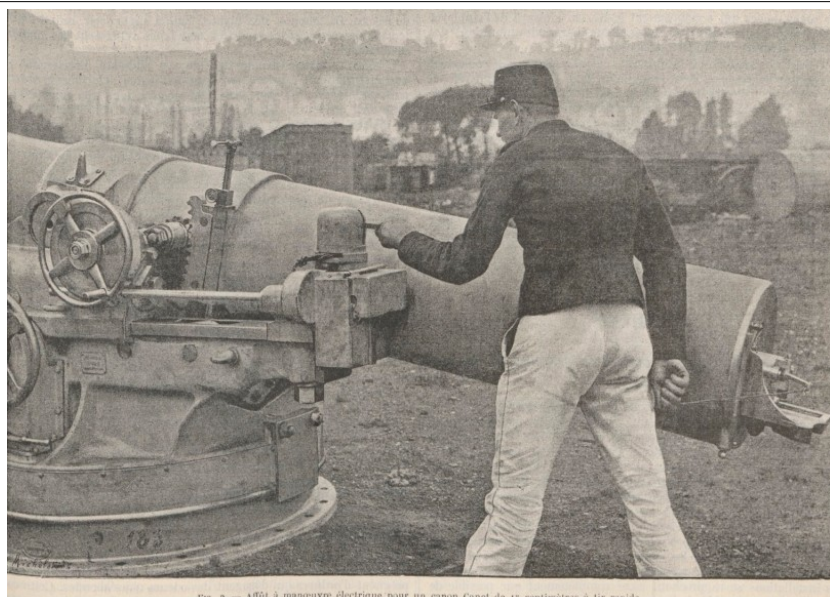
Illustration 119 : Manœuvre électrique sur un canon Canet
