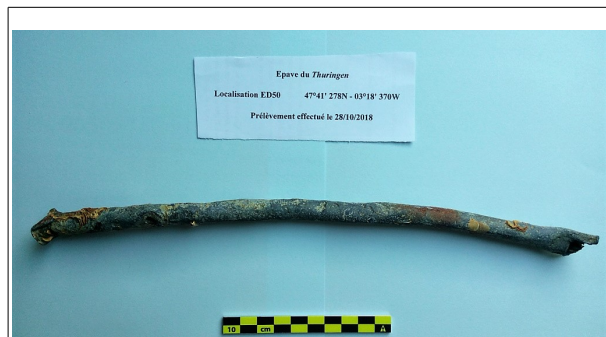
Illustration 86 : Prélèvement archéologique d'un câble au plomb 1911
