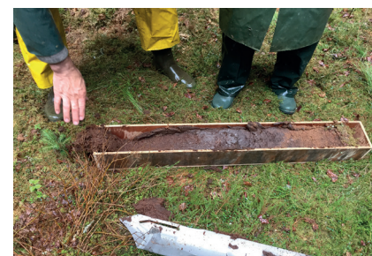
Figure 105 : Haut : mise en place du carottier Wardenaar, milieu : ouverture du carottier et pain de sédiment prélevé, bas : transfert du sédiment dans la boîte en bois de transport et de stockage. C. Schaal, 2016
