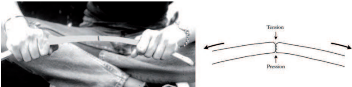
Figure 77 : Expérimentation et schéma illustrant la technique d'éclatement par flexion (Provenzano 2001, fig. 273).
