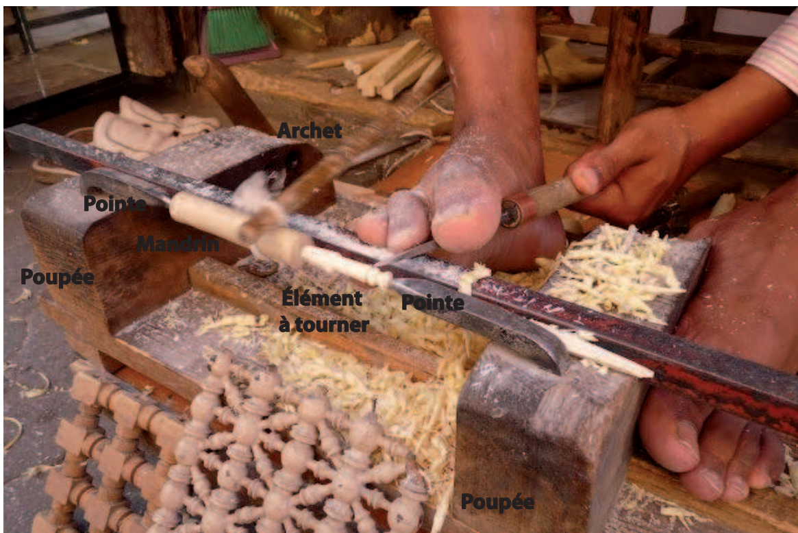
Figure 18 (détail de la figure 20) : Photographie d'un tour à archet contemporain, Médina de Marrakech, 2007 (© C. Picod, http://cpicod.blogspot.fr/2013/11/blog-post_2.html ).
