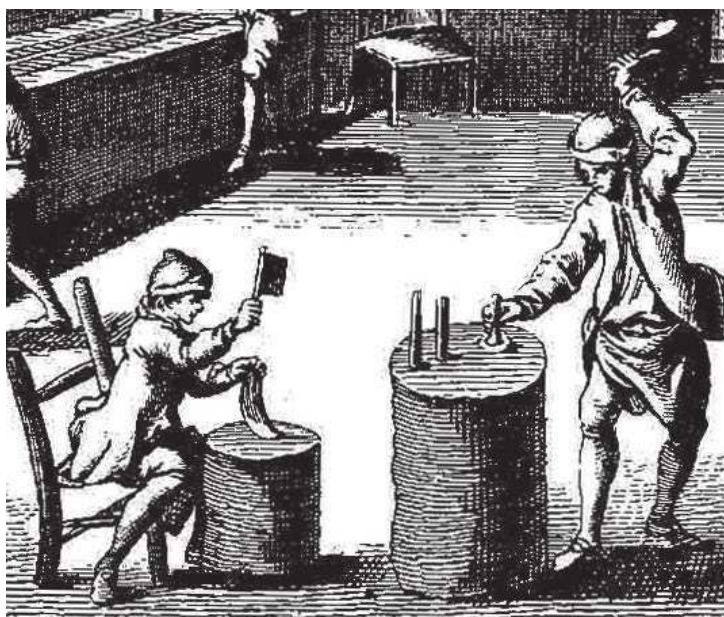
Figure 304 : 1 : L'Encyclopédie, Tabletier, Cornetier , ouvriers travaillant les étuis cornés aplatis, 2 : outil tranchant potentiellement utilisé par l'ouvrier de gauche, XVIII e siècle, France (Diderot et d'Alembert 1762-1772, vol. 8, pl. 1).
