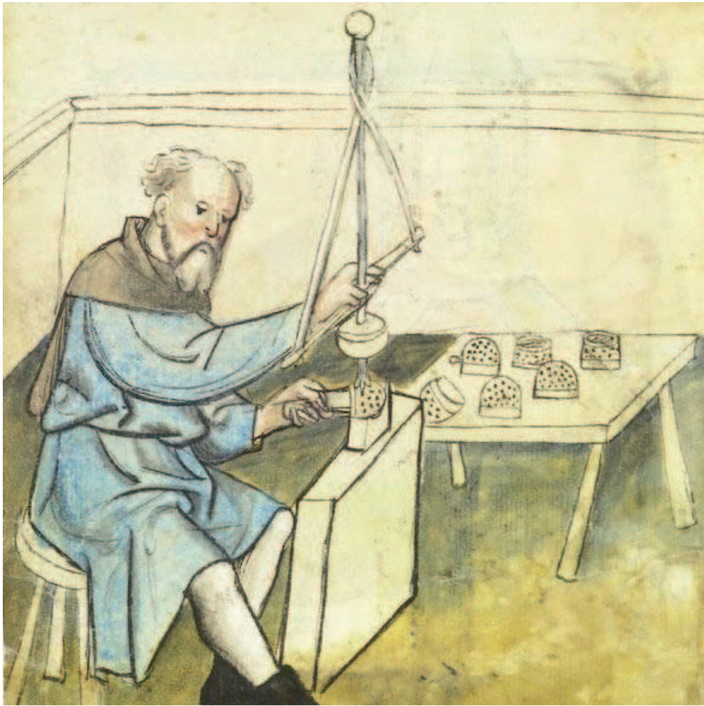
Figure 57 : Die Hausbücher der Nürnberger Zwölfbrüderstiftungen, Vingerhuter , artisan fabriquant un dé à coudre en utilisant un «perçoir à mouvement de pompe», 1425, Allemagne. Nuremberg, Stadtbibliothek, Amb. 317. 2, f° 5 v° (© Stadtbibliothek de Nuremberg, http://www.nuernberger-hausbuecher.de ).
