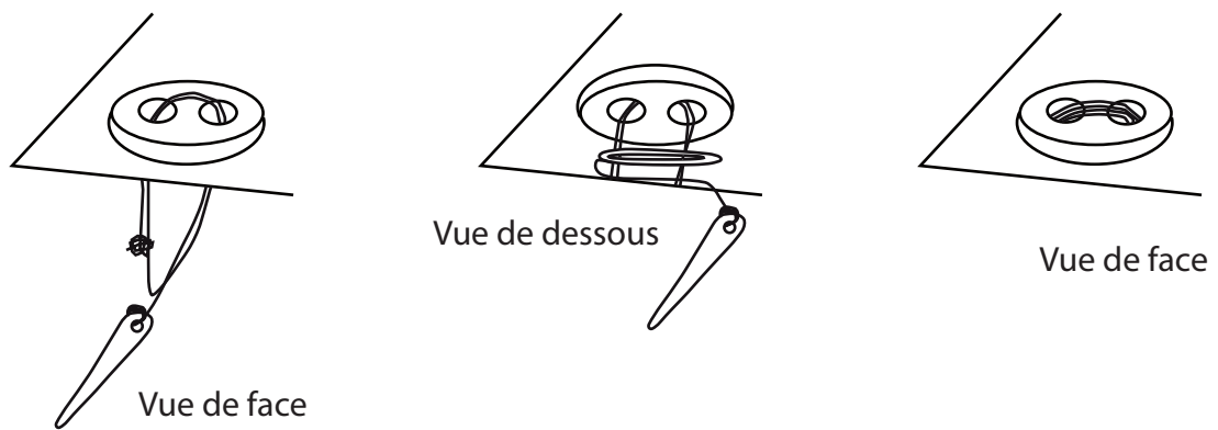
Figure 589 : Schéma montrant la fixation d'un bouton à plusieurs oeillets.
