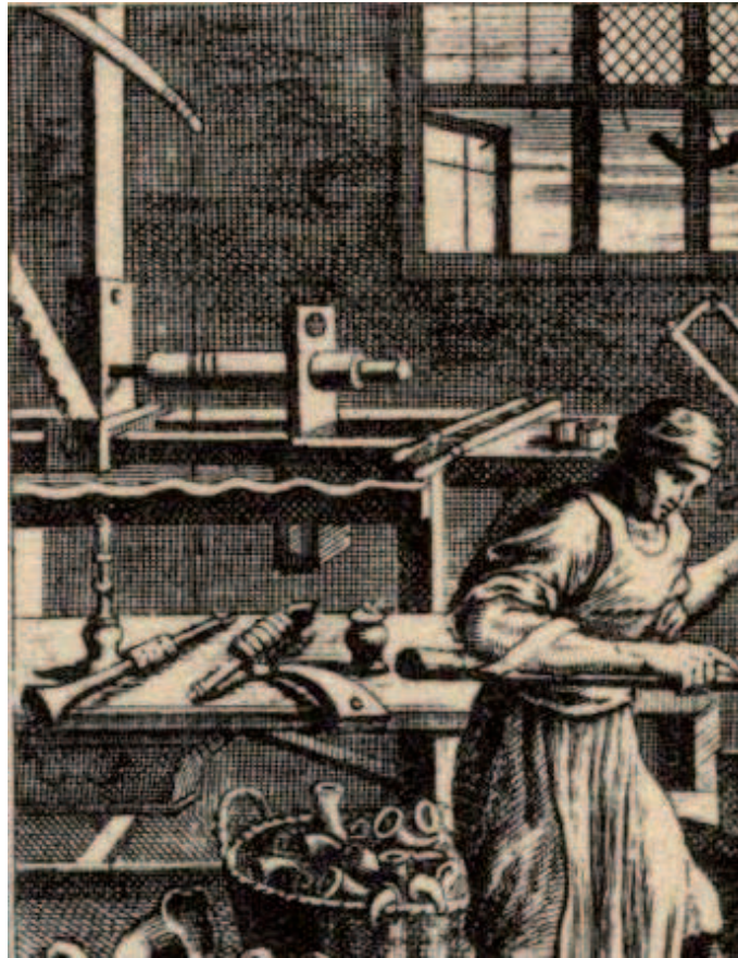
Figure 28 : Johann Christoph Weigel, Abbildung der gemein-nützlichen Haupt-Stände [...] , Der Horndreher , Atelier d'un artisan cornetier avec en arrière plan un tour à perche et à pédale, 1698, Allemagne (Weigel 1698, pl. 145).
