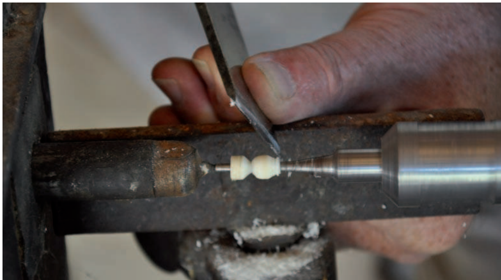
Figure 629 : Tournage de perles jointives à l'aide d'un ciseau (technologue C. Picod).
