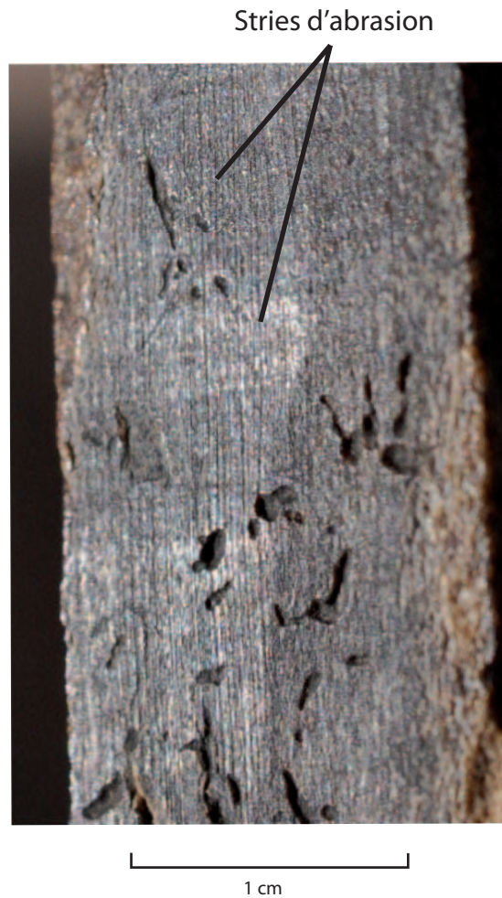
Figure 39 : Stries d'abrasion visibles sur un support.
