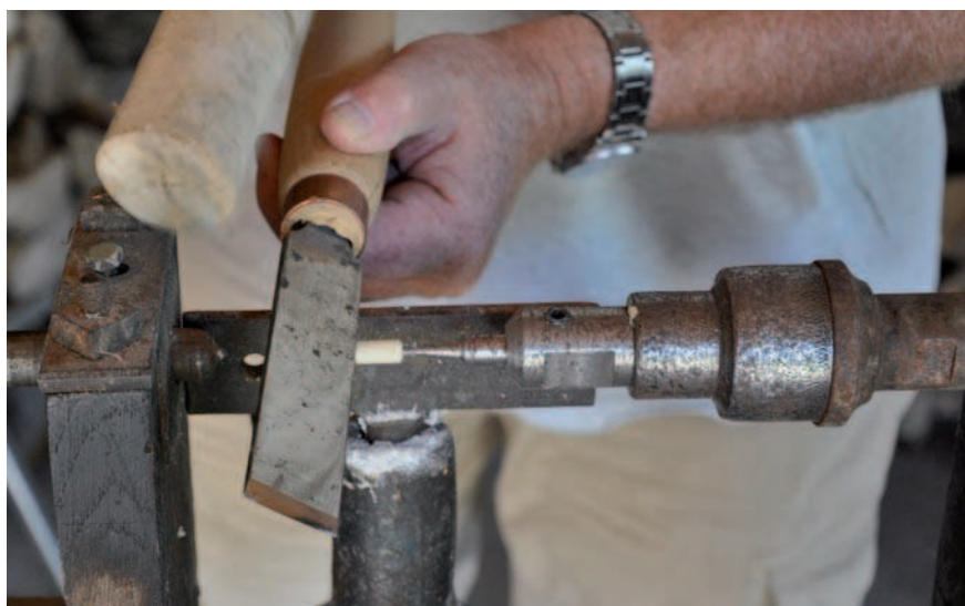
Figure 624 : Mise en place de la baguette d'os sur le tour à pédale (technologue C. Picod).
