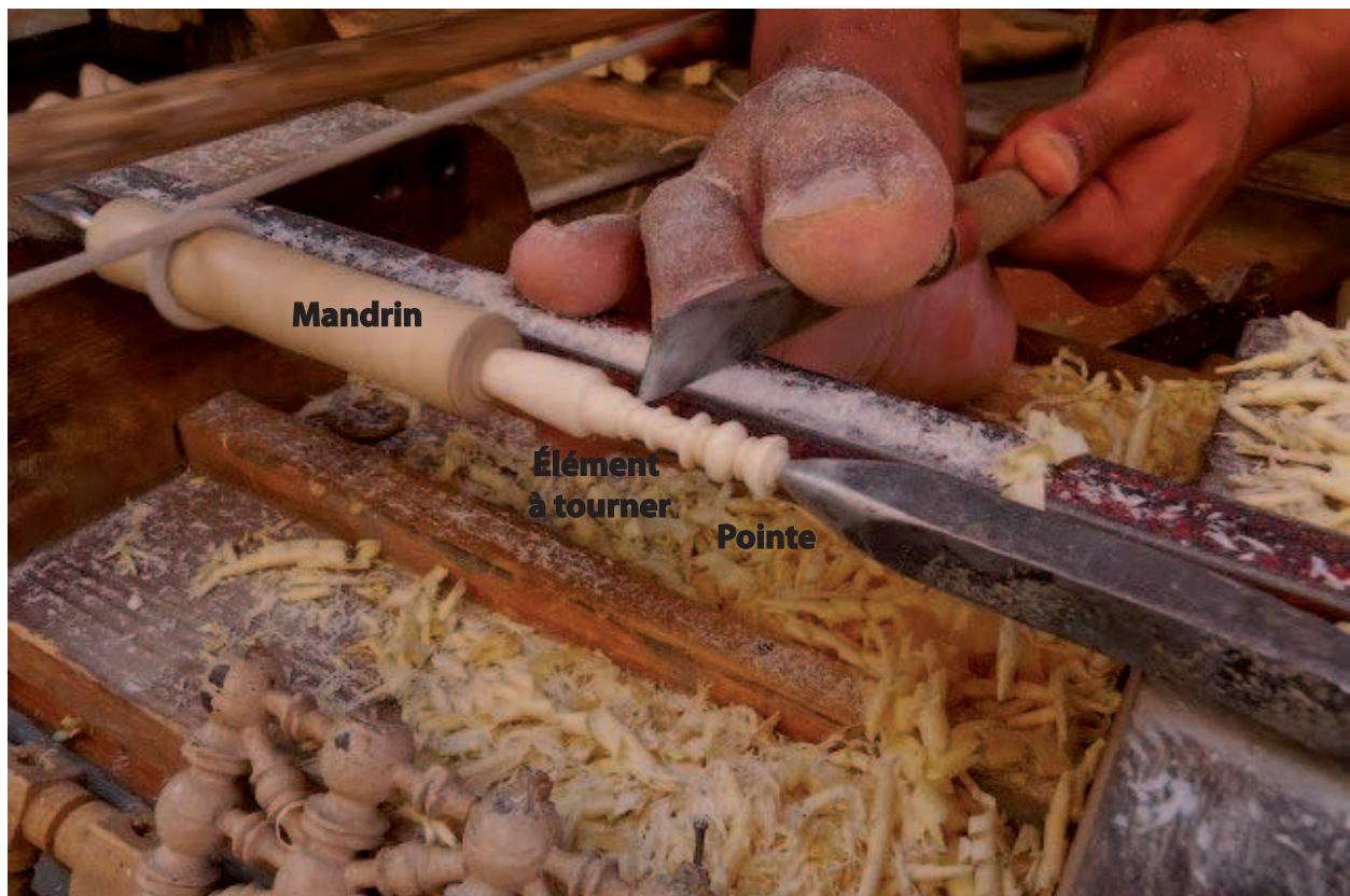
Figure 19 (détail de la figure 20) : Photographie d'un tour à archet contemporain, Médina de Marrakech, 2007, agrandissement montrant le mode de fixation de l'élément à tourner avec d'un côté la pointe, de l'autre le mandrin (© C. Picod, http://cpicod.blogspot.fr/2013/11/blog-post_2.html ).
