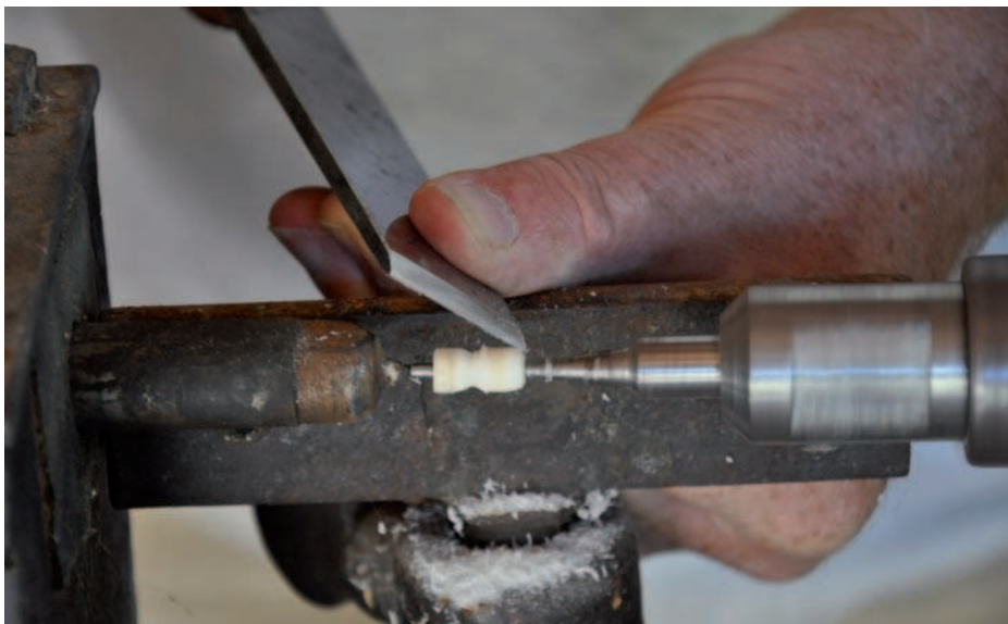
Figure 627 : Tournage de perles jointives à l'aide d'un ciseau (technologie C. Picod).
