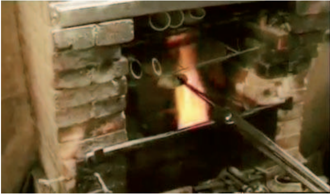
Figure 290 : Chauffe et ramollissement des étuis cornés avant leur ouverture (© www.peignecorne.com).
