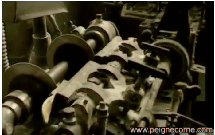
Figure 691 : Stadiuse actuellement utilisée pour le sciage mécanisé des dents des peignes en corne (www.peignecorne.com).
