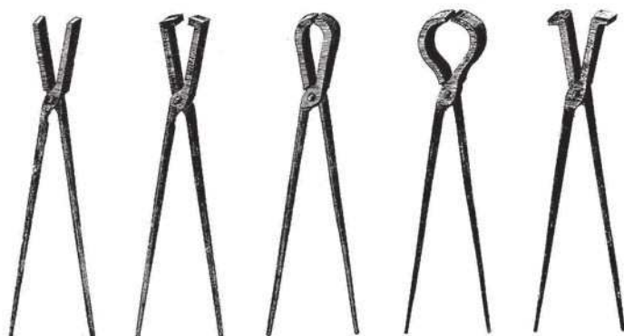
Figure 299 (dét. fig. 288) : L'Encyclopédie, Tabletiers, Cornetiers, tenailles pour aplatir l'étui corné, XVIII e siècle, France
