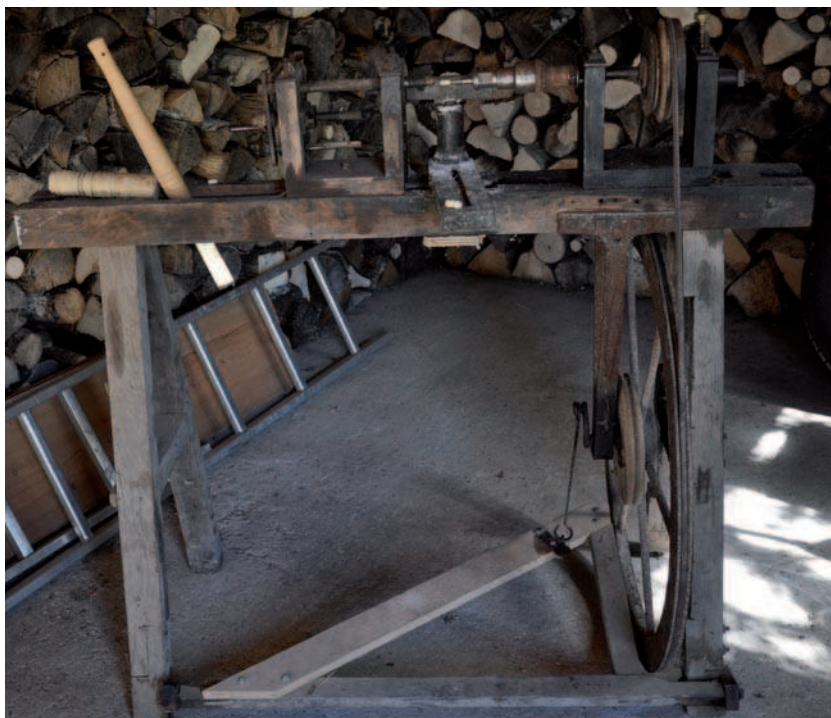
Figure 623 : Tour à pédale utilisé par C. Picod pour tourner les perles en os
