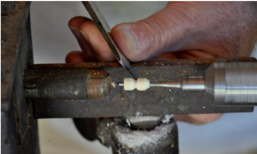
Figure 628 : Tournage de perles jointives à l'aide d'un ciseau (technologue C. Picod).
