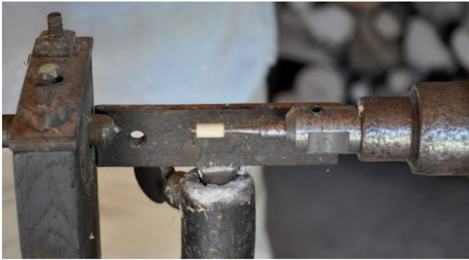
Figure 625 : Mise en place de la baguette d'os sur le tour à pédale (technologie C. Picod).
