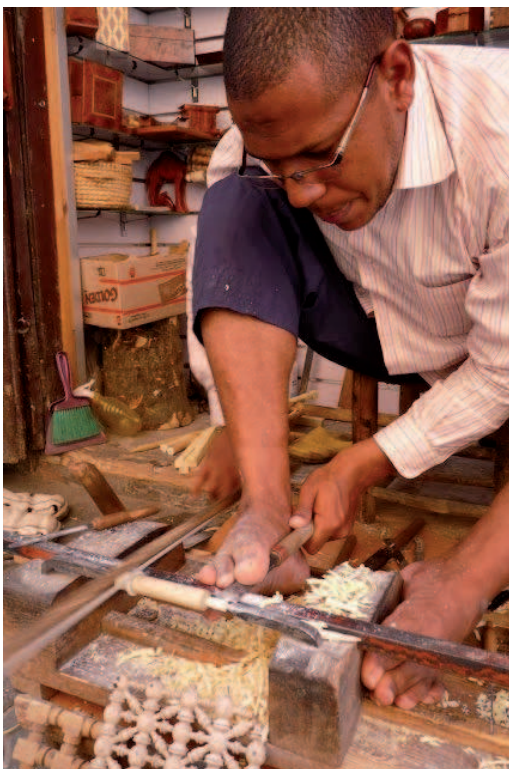
Figure 20 : Photographie d'un artisan tourneur à l'archet montrant le positionnement de ses mains et de ses pieds, Médina de Marrakech, 2007 (© C. Picod, http://cpicod.blogspot.fr/2013/11/blog-post_2.html ).
