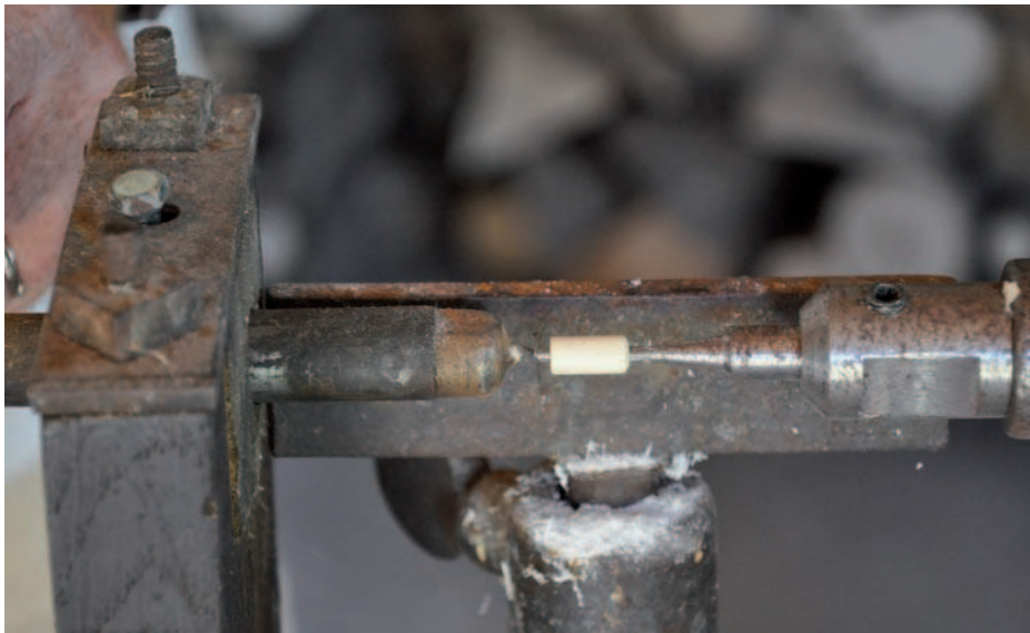
Figure 626 : Baguette d'os fixée sur le tour à pédale (technologie C. Picod).
