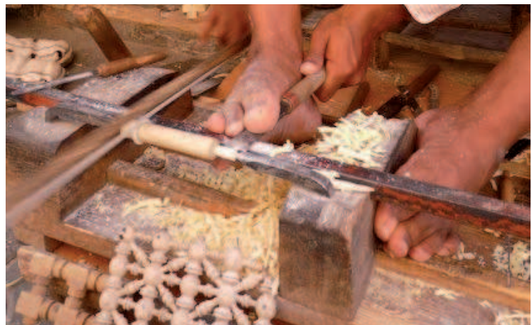
Figure 20 : Photographie d'un artisan tourneur à l'archet montrant le positionnement de ses mains et de ses pieds, Médina de Marrakech, 2007 (© C. Picod, http://cpicod.blogspot.fr/2013/11/blog-post_2.html ).
