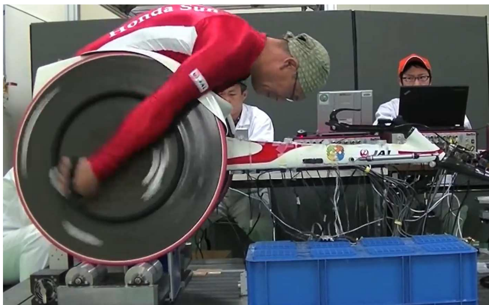
FIGURE 8.16 – Banc de test de la marque de fauteuil d'athlétisme japonaise Honda.
