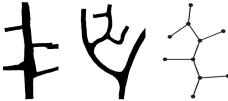
Figure 4.2 : Deux réseaux viaires différents (gauche et milieu) représentés par le même graphe topologique (droite). Source : (Marshall, 2005)
