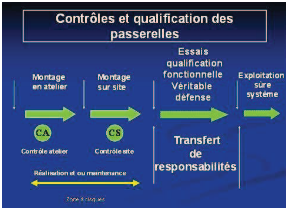
Figure Ann. 33 – Contrôle et qualification des passerelles.
