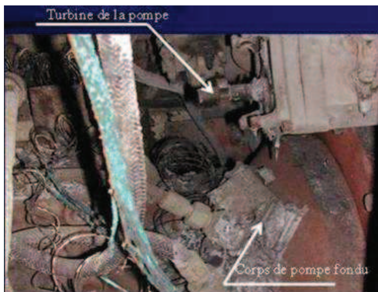
Figure 97 - Découverte de l'emplacement de la pompe défaillante.
