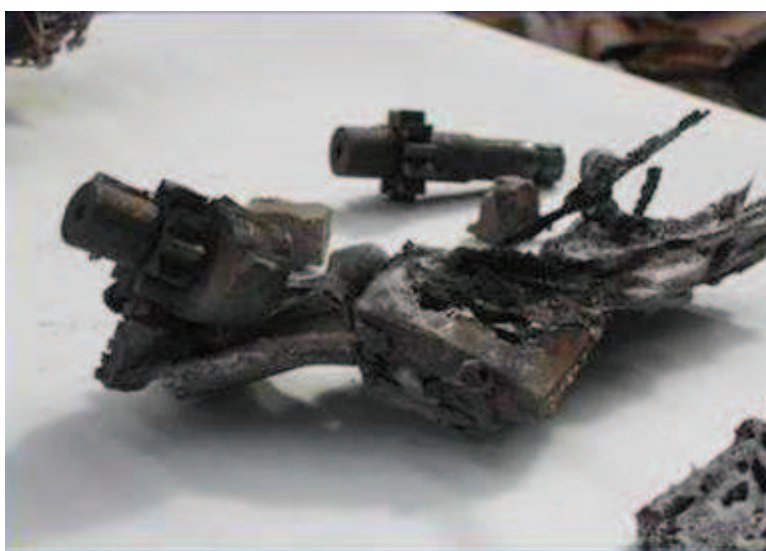
Figure 98 - Fragments des deux pompes ayant fondu.
