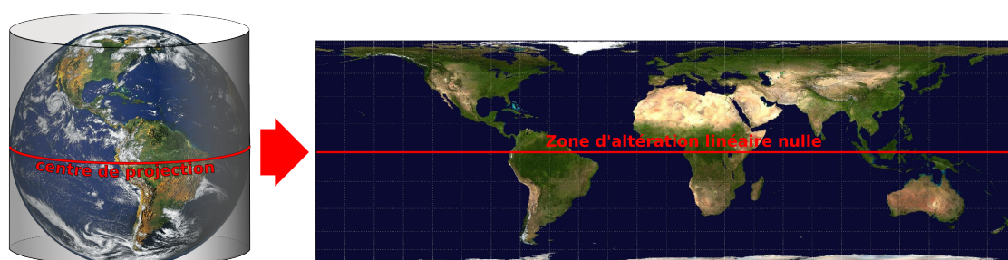
FIGURE 3.3 – Développement de la surface terrestre sur un cylindre. Le parallèle tangent est situé sur l'équateur (projection Mercator).
