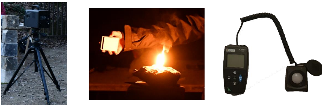
Figure 74 : Matériel utilisé lors des mesures. De gauche à droite : Spectroradiomètre Konica Minolta CS-2000 (cl. P. Mora), Diffuseur parfait (cl. P. Mora), Luxmètre Chauvin Arnoux 1110.
