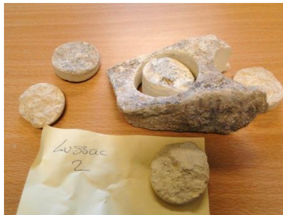
Figure 98 : Carottage en cours d'un échantillon du site de Cussac (CSTB).
