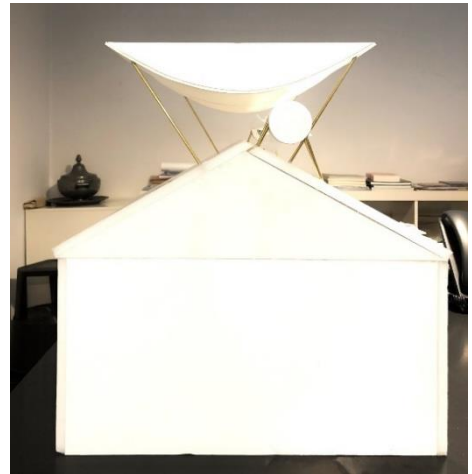
Figure 250. Maquette finale optimisée avec allongement de la turbine et contreventement du foil de l'étude
