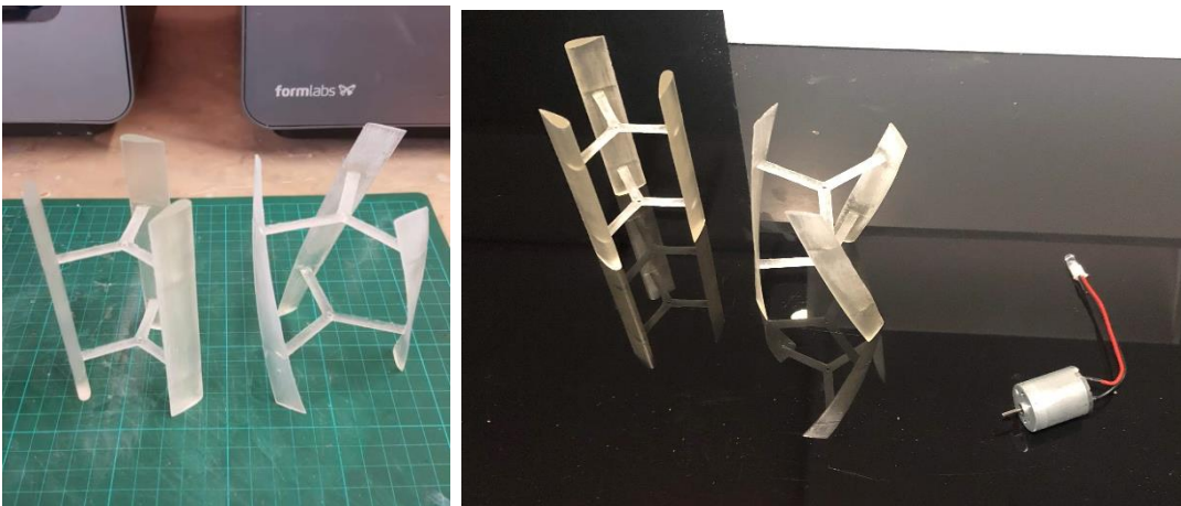
Figure 299. Impression 3D d'éoliennes avec turbines de générateur
