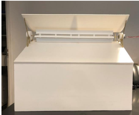
Figure 250. Maquette finale optimisée avec allongement de la turbine et contreventement du foil de l'étude
