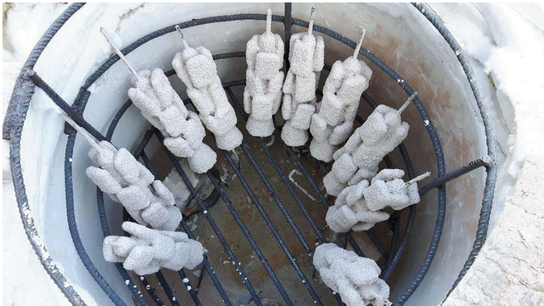
Fig. 216. Moules de coulée après dégrillage et cuisson (© J. Devogelaere).
