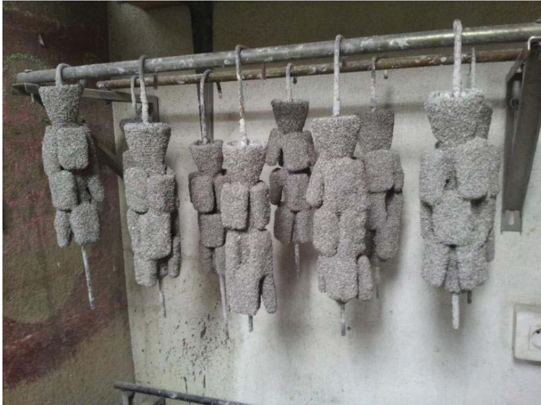
Fig. 215. Moules de coulée avant cuisson (© J. Devogelaere).
