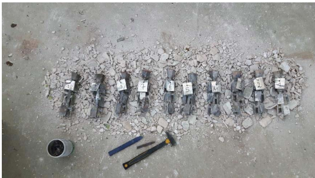
Fig. 220. Décochage des moules de coulée (© J. Devogelaere).
