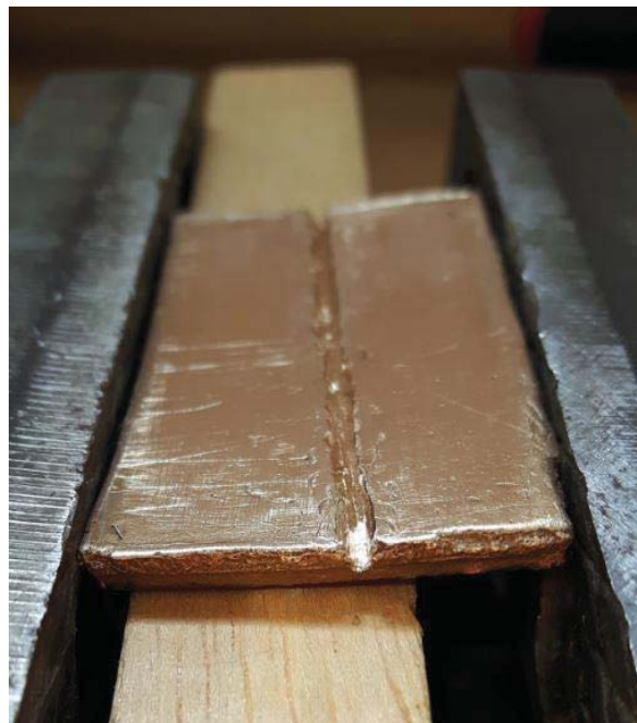
Fig. 228. Damasquinage en cours de réalisation (© J. Devogelaere).
