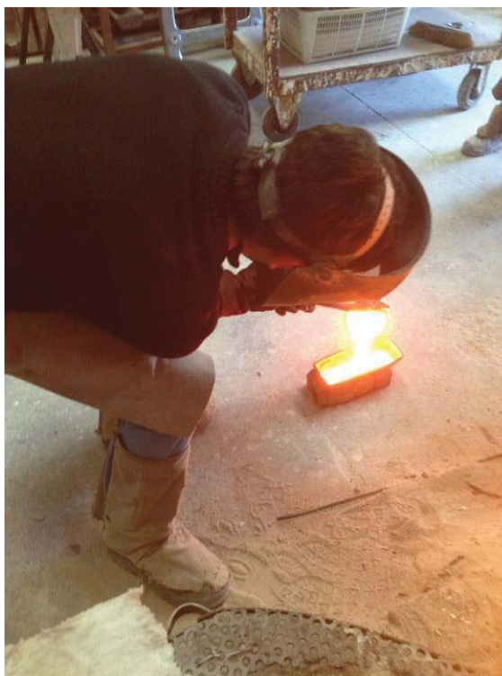
Fig. 217. Lingotage d'un alliage (© Delta 960°).
