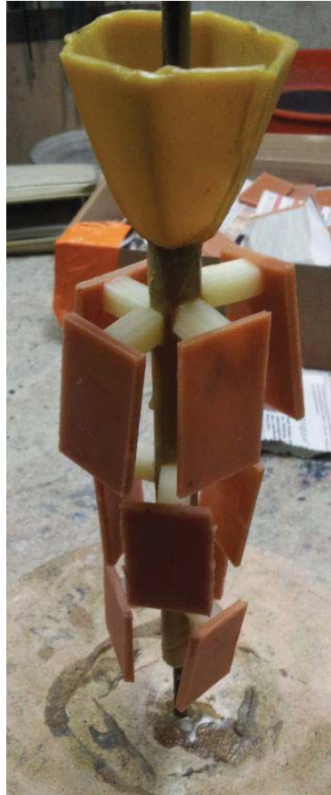
Fig. 213. Modèle en cire d'une grappe de coulée avec les dix plaquettes (© J. Devogelaere).
