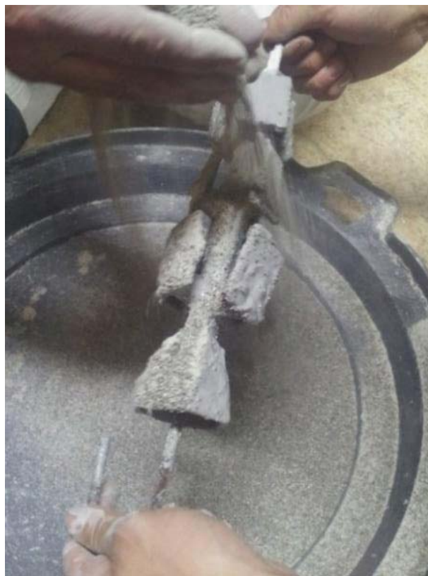
Fig. 214. Moule de coulée en cours de réalisation (© Delta 960°).
