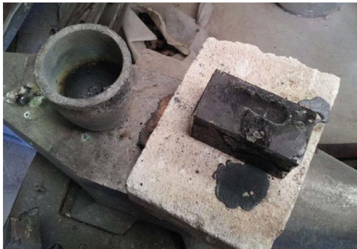
Fig. 225. Lingotage du bronze de Corinthe (© J. Devogelaere).
