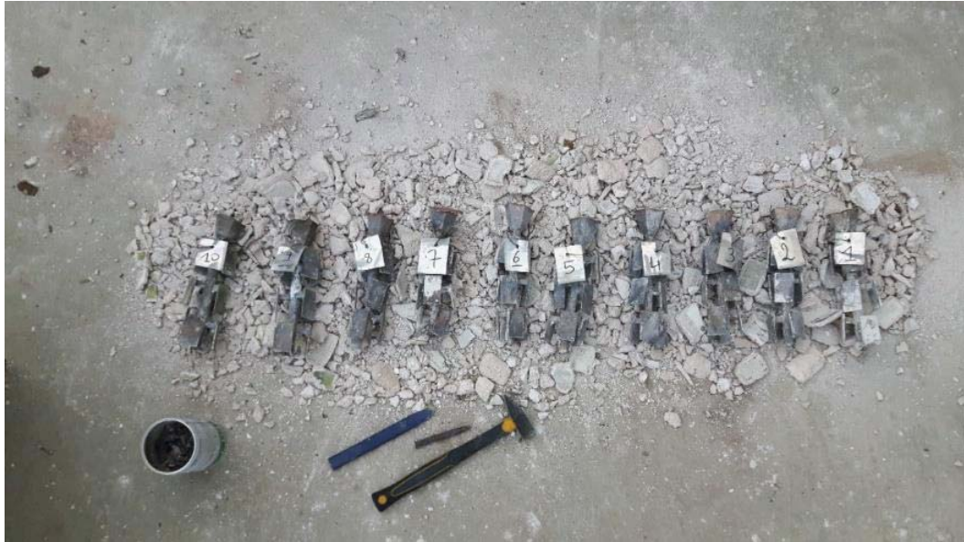
Fig. 220. Décochage des moules de coulée (© J. Devogelaere).
