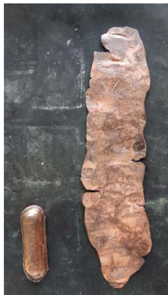
Fig. 226. Lingots en bronze de Corinthe, l'un avant recuit et martelage (à gauche) et le second après recuit et martelage (à droite) (© J. Devogelaere).
