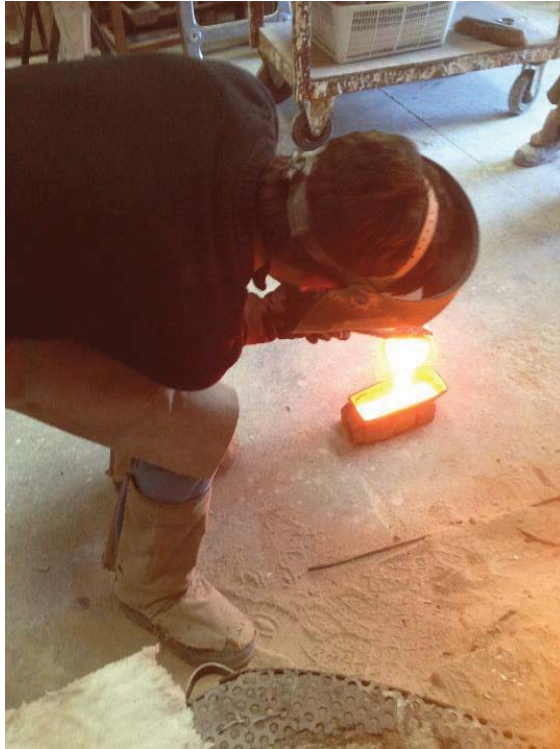
Fig. 217. Lingotage d'un alliage (© Delta 960°).
