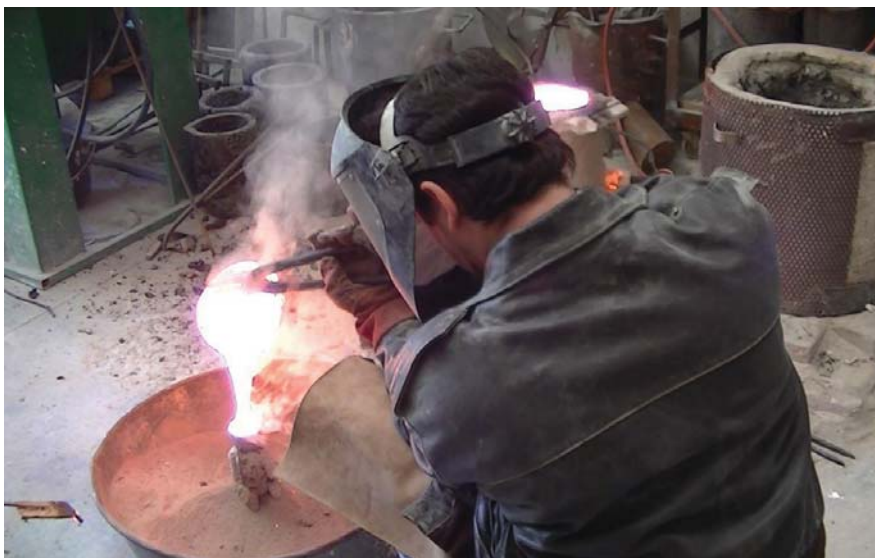
Fig. 219. Coulée du bronze dans le moule en grappe (© Delta 960°).
