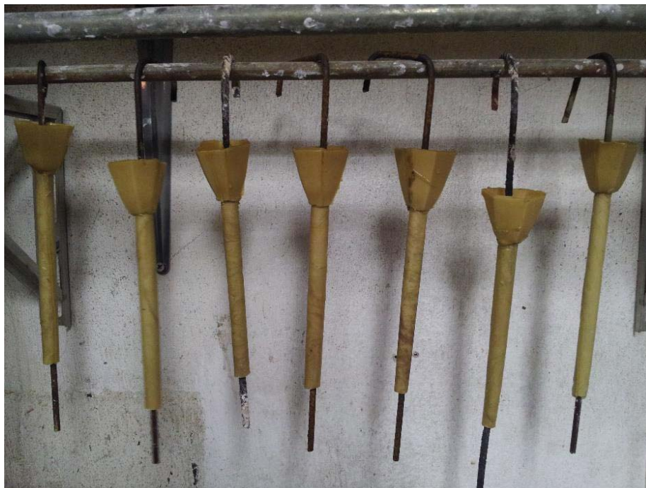
Fig. 212. Modèles en cire de l'armature des grappes de coulée (© J. Devogelaere).
