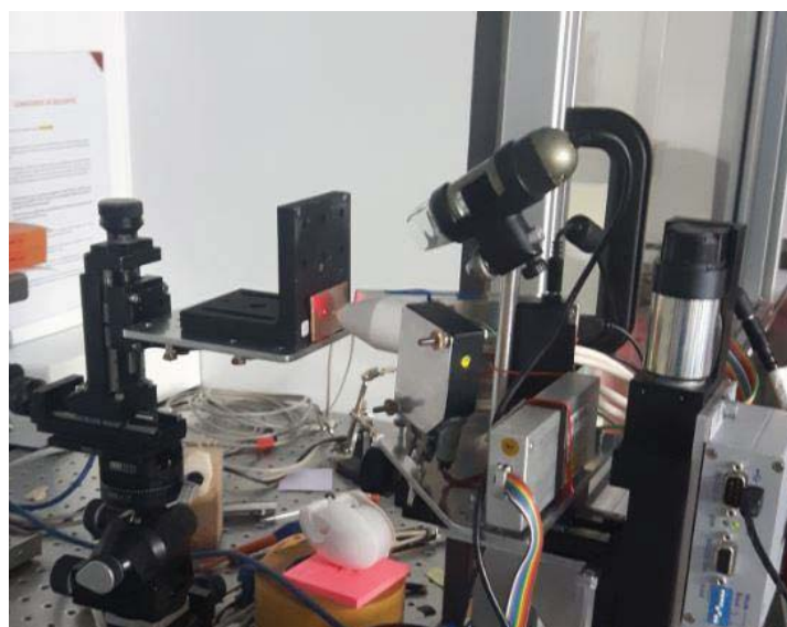
Fig. 246. Spectromètre de la fluorescence des rayons X (© J. Devogelaere).
