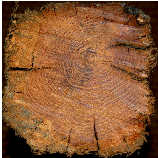
Fig. 95 : Tranche d'un chevron de 1256 de la cathédrale de Bourges. Cernes larges liés à une croissance rapide.
