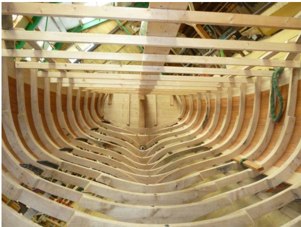
Figure 36 : Les membrures dans une construction de la coque « membrures d'abord »
