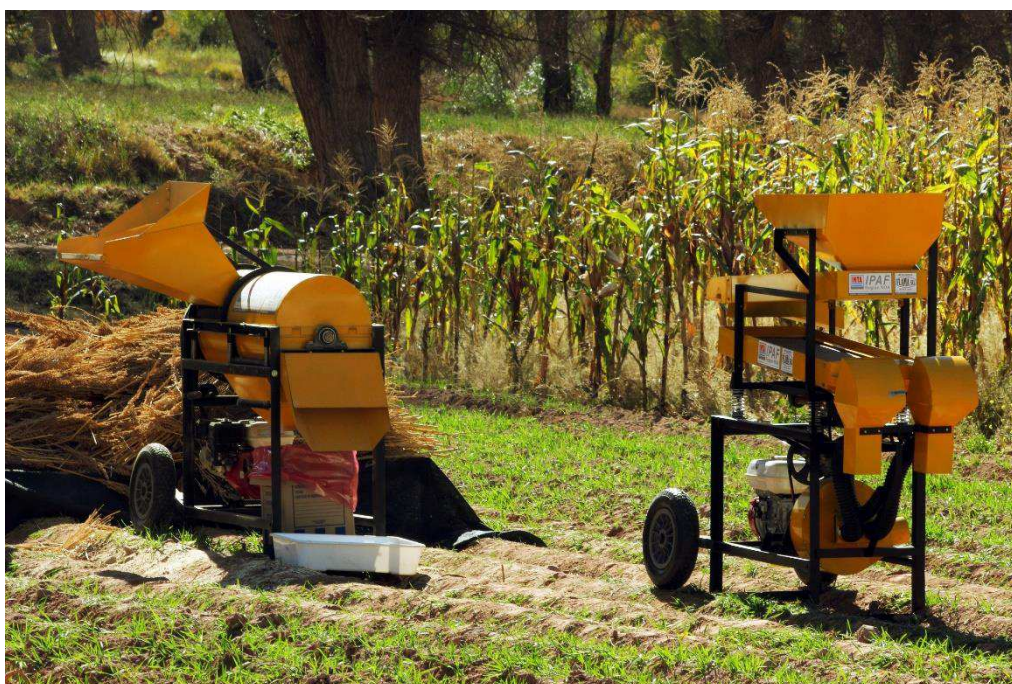
Foto N°11: Trilladora y clasificadora de quinua (MTA-C y MCL-A).
