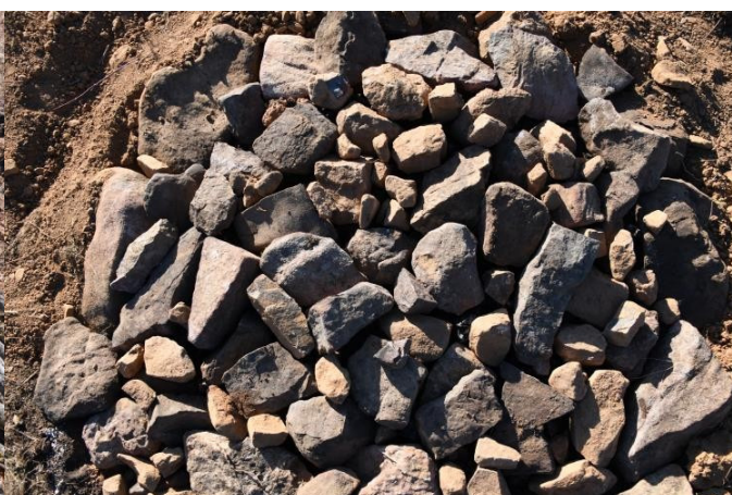
Fig. 4 Fermeture de la charbonnière avec un lit de pierres Cuisson M. Dahmani Ain Ainza (Retba) 27 septembre 2019
