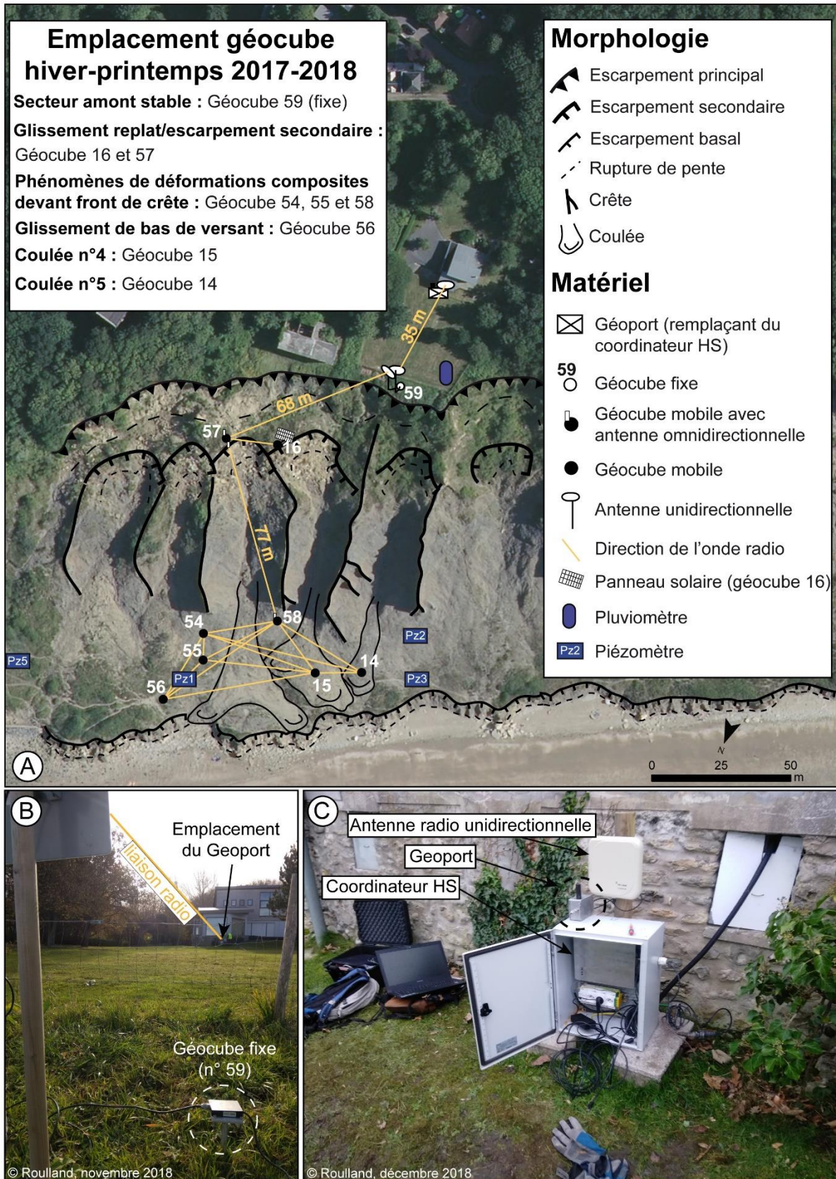
Figure 7.3 : Présentation de l'implantation du dispositif géocube sur le site DYNALIT pour l'année 2018 - 2019 ; A) Plan d'implantation et de répartition du dispositif géocube ; B) Illustration de l'antenne radio unidirectionnelle du géocube 59 fixe en liaison directe avec le géoport ; C) Illustration du nouveau dispositif de réception des données géocubes (géoport)
