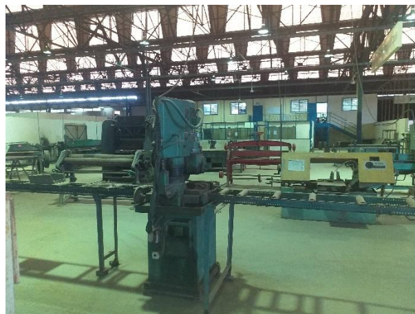
Figure 2: Fraise scie, avec une scie à ruban en arrière-plan (juillet 2021)
