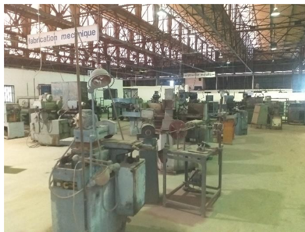
Figure 1: Fraise mécanique et touret à affuter (Juillet 2021)
