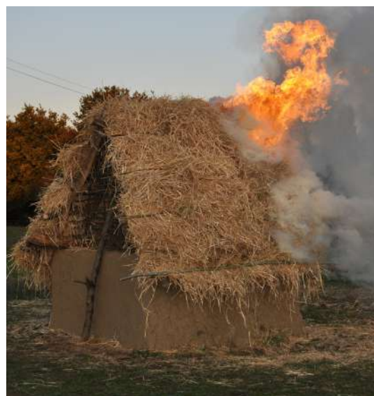
Fig. 5-137 - Incendie à 0min10 : le pan ouest du toit prend feu.
