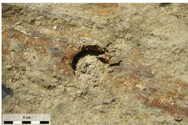
Fig. 3-06 - Épaisseur de la pellicule de bois visible après prélèvement d'un échantillon à l'emporte-pièce.
