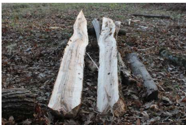
Fig. 5-60 - Obtention de deux demi-rondins tordus suite à la refente d'un tronçon aux fibres torses.
