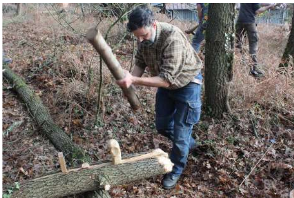
Fig. 5-54 - Refente en deux parties d'un rondin. Utilisation du Percuteur_3 et des Coins_1, 4 et 5 (de g. à d.).
