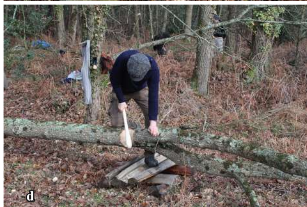
Fig. 5-46 - Tronçonnage à la hache. a. en position avec un genou au sol ; b. en position à genoux ; c. position debout légèrement penché vers l'avant ; d. utilisation d'un rehausseur pour être à bonne hauteur de frappe ; e. position debout sur le tronc et penché vers l'avant.
