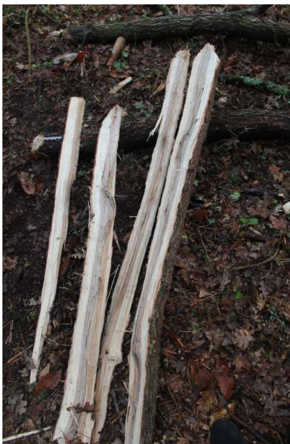
Fig. 5-56 - Produit obtenu après des refentes en quart et en quartier.
