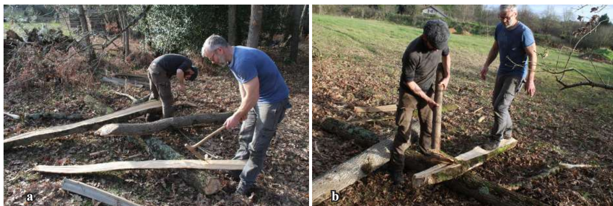
Fig. 5-65 - Travail de régularisation des planches. a. à l'herminette ; b. au coin (Coin_3) et percuteur.
