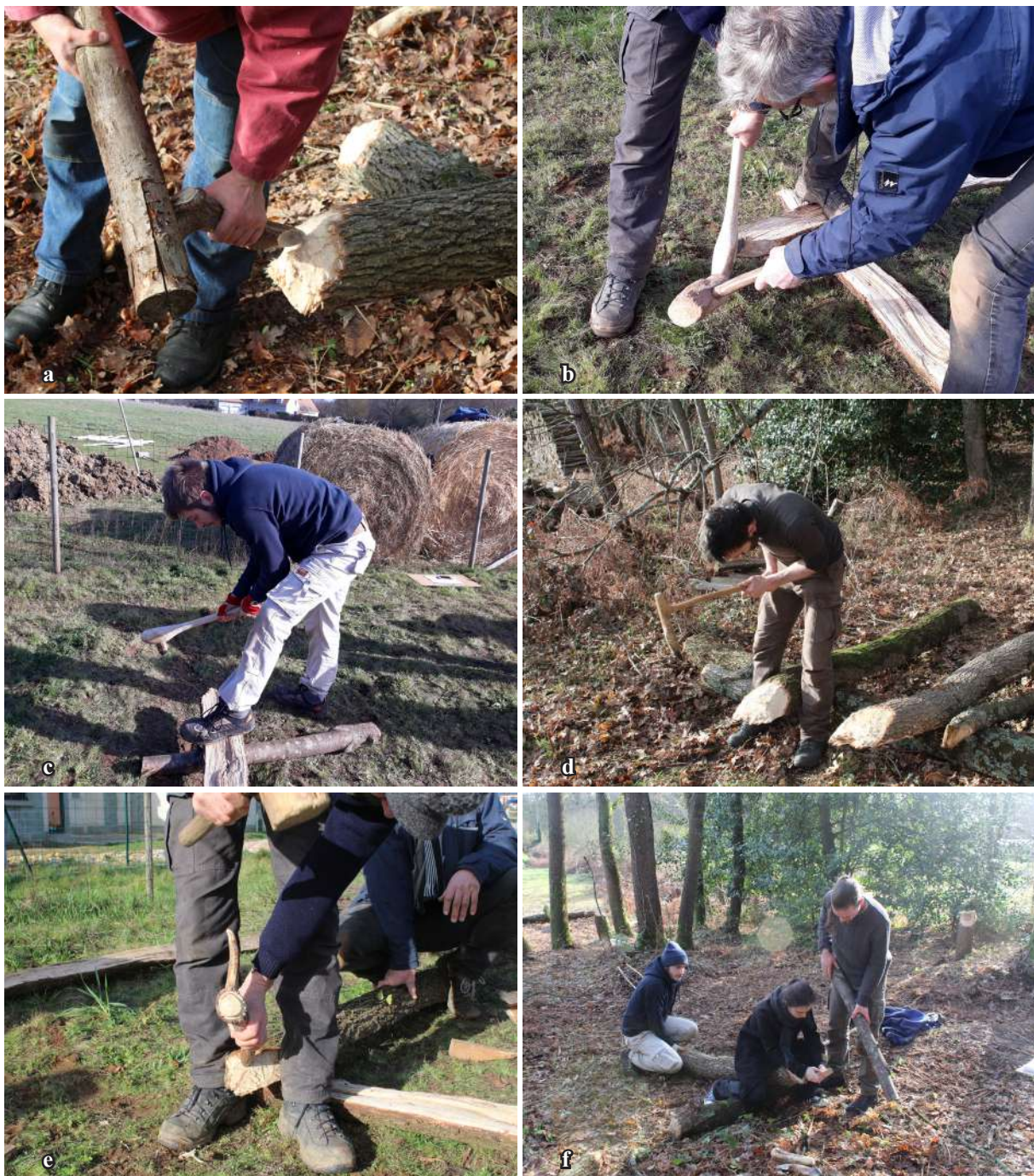
Fig. 5-58 - Différentes amorces de refente et les positions. a. au coin en bois de cerf (Coin_7) ; b. avec l'utilisation d'une hache comme merlin et d'un maillet (Percuteur_5) ; c. avec utilisation d'une hache en percussion lancée ; d. avec utilisation d'une herminette en percussion lancée ; e. amorce seule en position debout les jambes de chaque côté du tronc ; f. amorce à deux personnes, une est à califourchon sur le tronc et tient le coin, la deuxième est sur le côté et actionne le percuteur.
