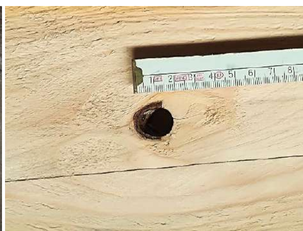
Fig. 3-31 - Nœud mort dans une planche de pin. Cliché par F. Bacoup.
