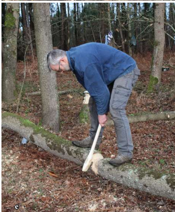
Fig. 5-46 - Tronçonnage à la hache. a. en position avec un genou au sol ; b. en position à genoux ; c. position debout légèrement penché vers l'avant ; d. utilisation d'un rehausseur pour être à bonne hauteur de frappe ; e. position debout sur le tronc et penché vers l'avant.
