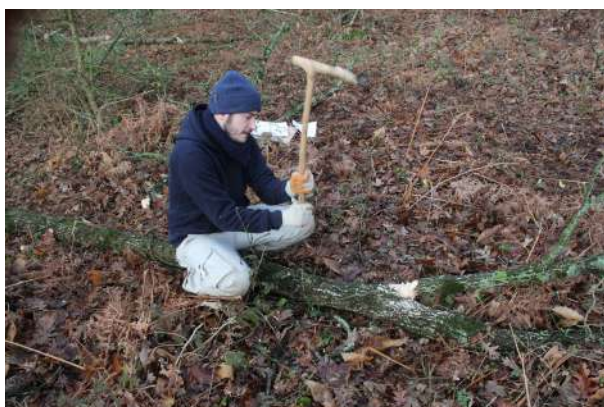
Fig. 5-43 - Ébranchage à l'herminette par une personne de niveau « 2-familier » à califourchon sur le tronc.
