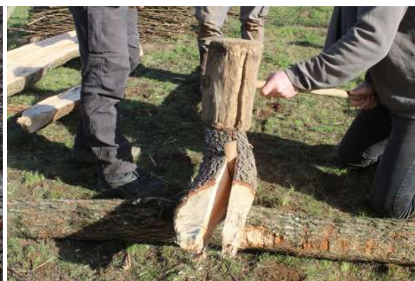
Fig. 5-61 - Refente radiale d'un demi-rondin en pseudo-planche.
