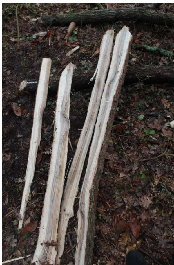
Fig. 5-56 - Produit obtenu après des refentes en quart et en quartier.
