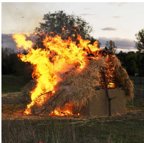
Fig. 5-139 - Incendie à 2min14 : le chevron sud du pan est s'écroule entraînant la partie sud du pan.
