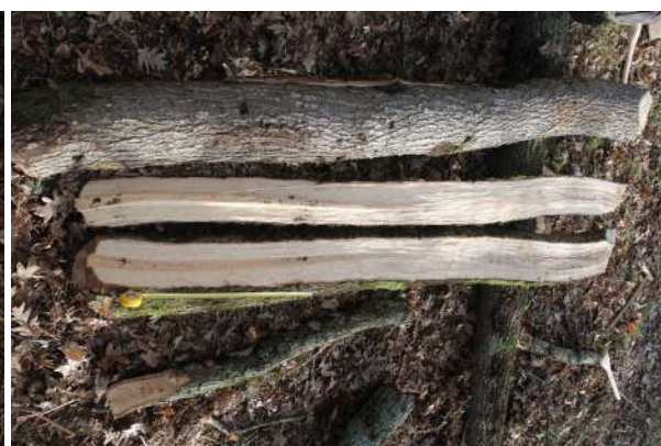
Fig. 5-64 - Planches obtenues par débit sur dosse.
