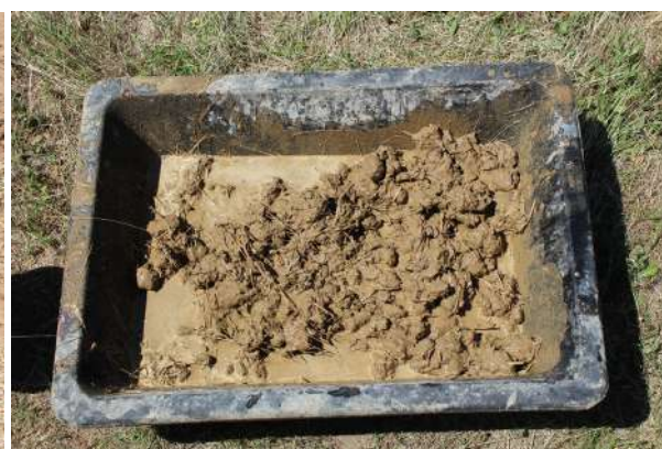
Fig. 5-97 - Préparation d'une terre à bâtir pour enduit en auge.
