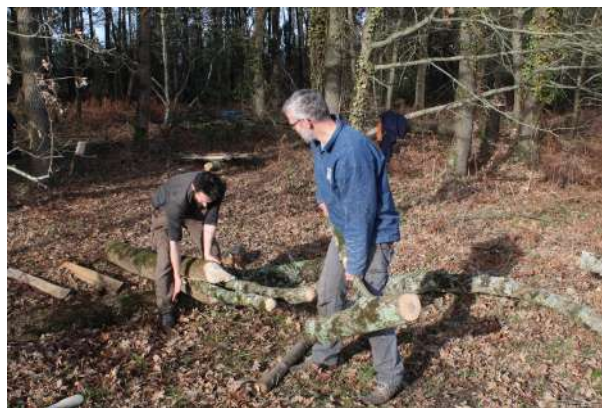
Fig. 5-57 - Refente en deux parties d'un rondin à l'aide d'une masse monoxyle (Percuteur_4) et de coins longs (Coin_6).
