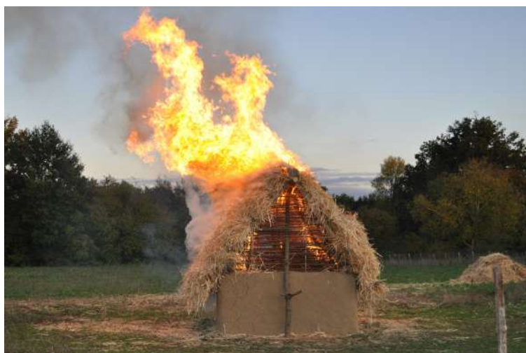
Fig. 5-138 - Incendie à 1min10 : le haut du pan est prend feu.
