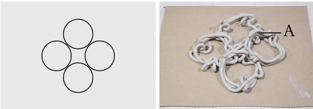
Fig. 9.39 — Échantillon n° 3 : trajectoires de déposition et structure obtenue au terme de l'étape d'initialisation. A : point de contact de deux formations circulaires.
