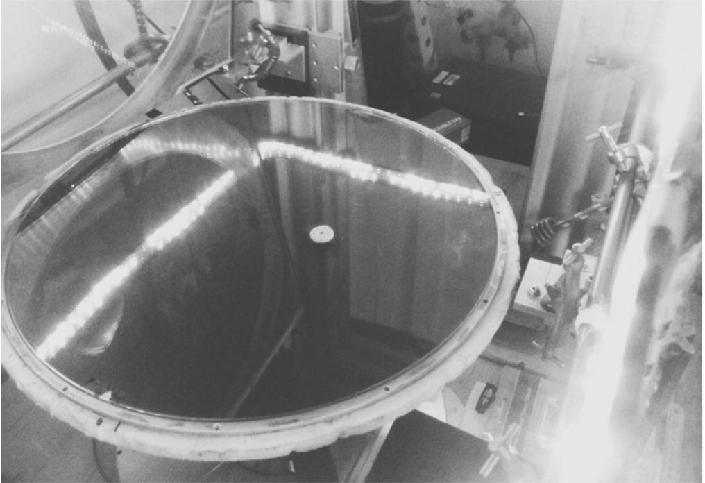
Fig. 12.6 — Test des prototypes de marcheur sur le dispositif de vibration de l'équipe EC2M.
