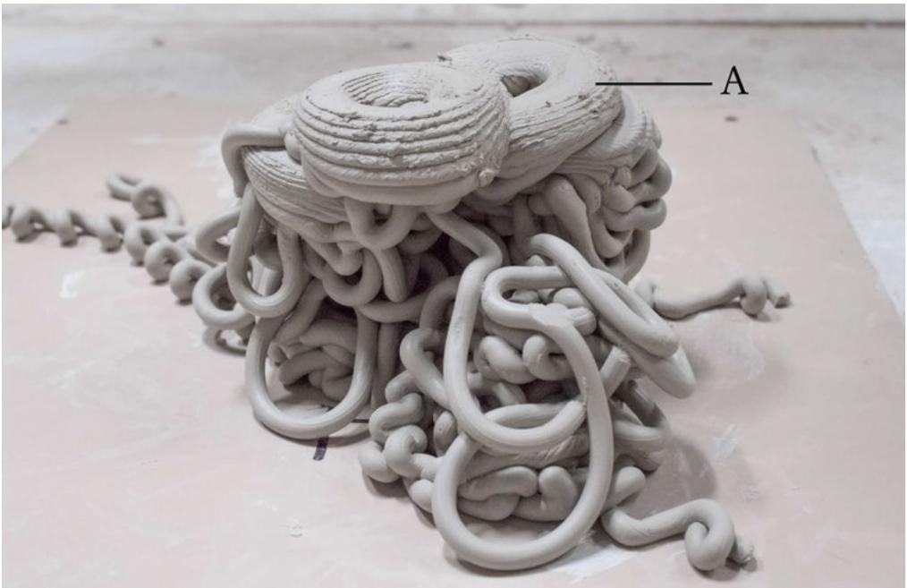
Fig. 9.36 — Échantillon n° 2 : structure finale obtenue. A : groupement de structures toriques de forte densité.
