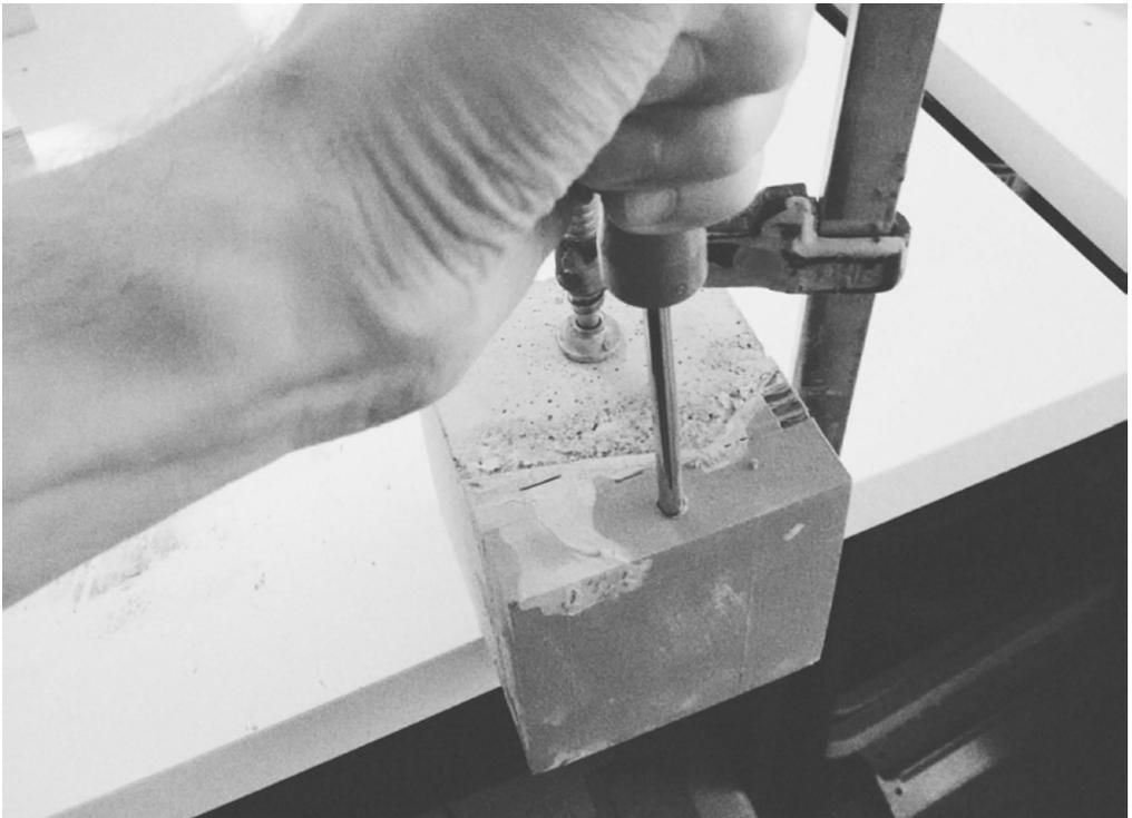
Fig. 7.14 — Séparation des deux parties de la pièce obtenue après séchage du béton.
