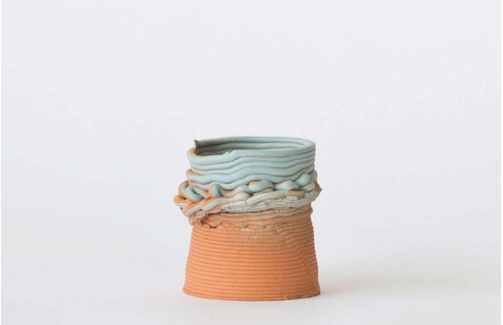
Fig. 1.1 — Olivier van Herpt, 3D Printing Ceramics, 2012–2013 : la modification en cours d'impression de la distance entre la buse d'extrusion et les couches précédemment déposées de pâte de céramique permet d'induire des variations radicales dans la structure de la pièce obtenue (source : <http://oliviervanherpt.com/3d-printing-ceramics>).
