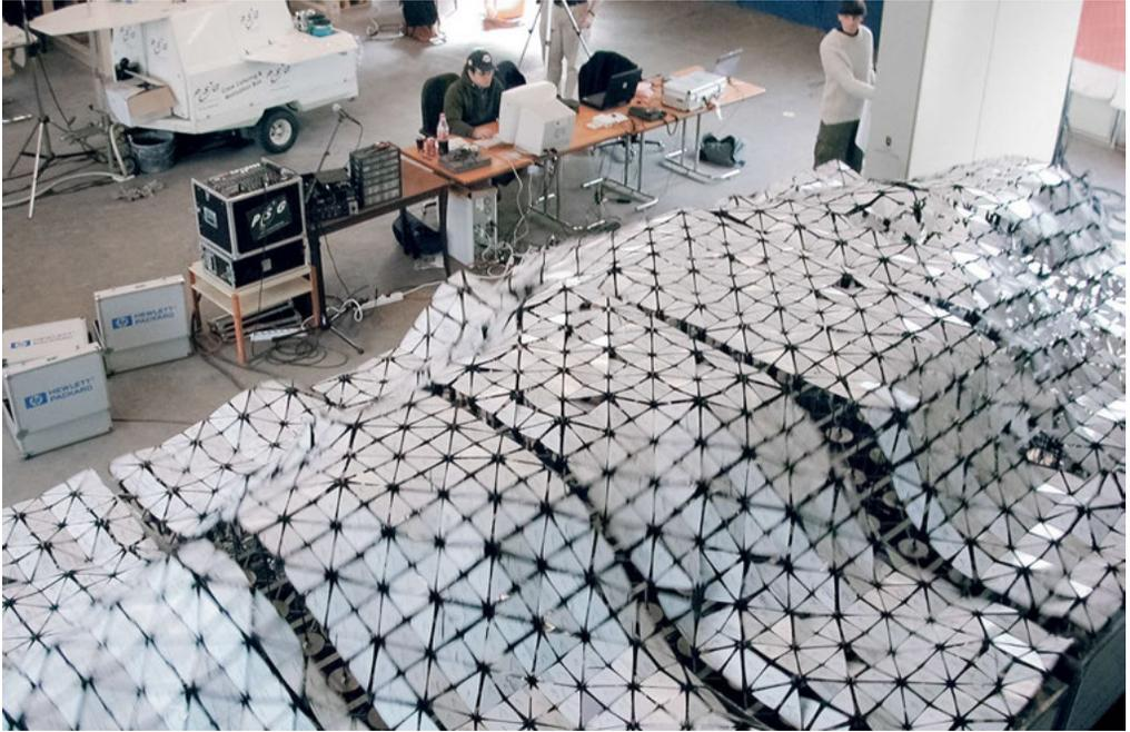
Fig. 8.2 — Test des différents modules d'Aegis Hyposurface. Le dispositif est usuellement présenté en position verticale, à la manière d'une façade (source : <http://fluxwurx.com/installation/?p=194>).
