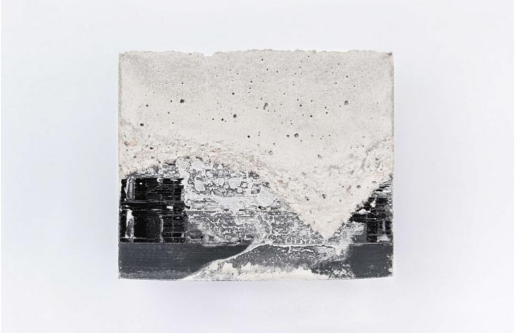
Fig. 7.13 — Vue du volume composite obtenu après séchage du béton.
