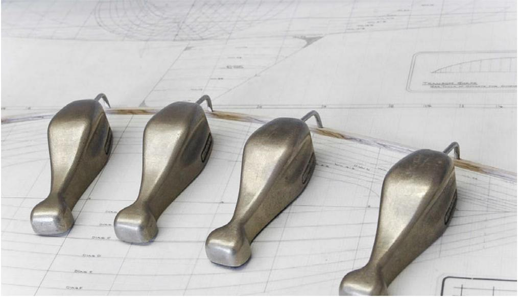
Fig. 3.2 — Spline mécanique maintenue sous tension à l'aide d'un jeu de poids (source : [http://www.edsonmarine.com/hi-res/index.php?pathextend=boating\\_accessories](http://www.edsonmarine.com/hi-res/index.php?pathextend=boating_accessories)).
