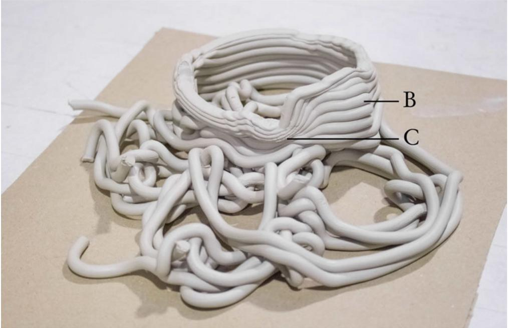
Fig. 9.40 — Échantillon n° 3 : structure obtenue au terme de l'étape n° 2. Zones de « compression » (C) et de « relâchement » (B).
