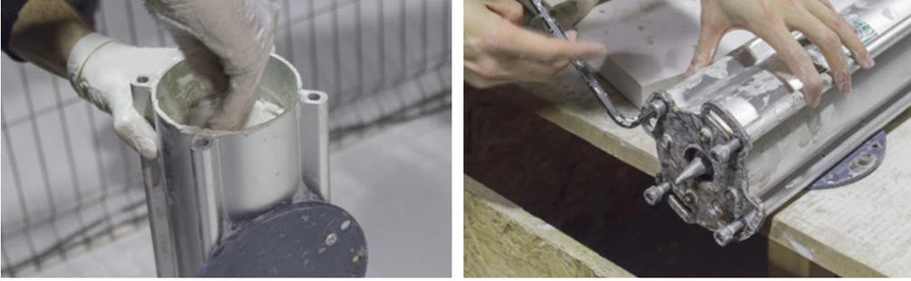
Fig. 9.13 — Préparation du réservoir d'argile utilisé dans la première version de l'extrudeur.
