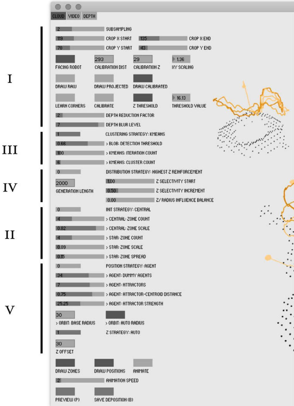
Fig. 9.14 — Localisation des fonctionnalités proposées par le logiciel sur son interface graphique : (I) construction et calibration du nuage de points, (II) génération des zones de déposition initiales, (III) calcul rétroactif des zones de déposition, (IV) distribution sélective du volume total d'argile déposé, (V) génération des trajectoires de déposition.
