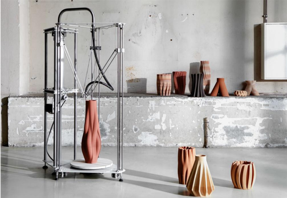
Fig. 9.12 — Imprimante 3D à céramique de type « delta » utilisée par Olivier van Herpt (source : <http://www.damnmagazine.net/2017/06/28/imprimer-le-monde>).
