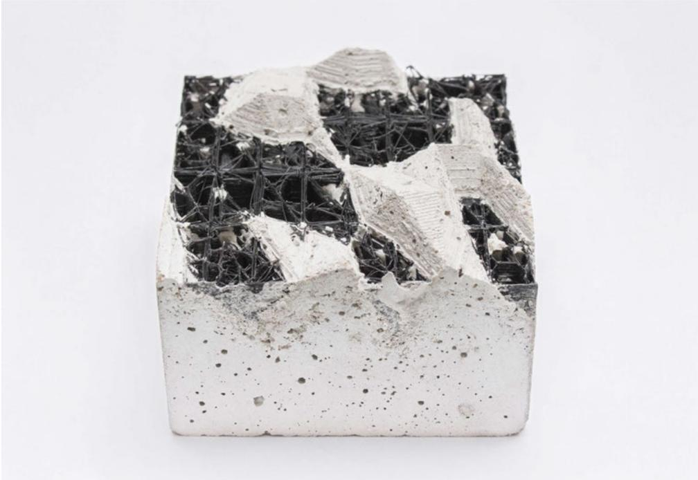
Fig. 7.15 — Artefact obtenu au terme de l'opération de démoulage.
