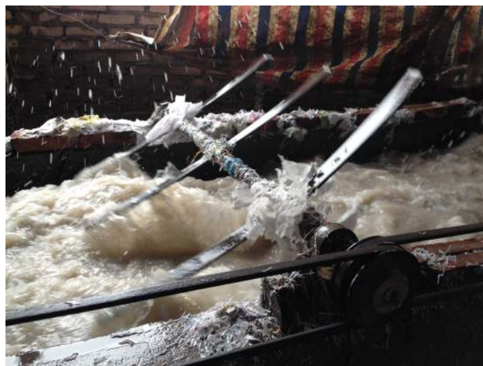
L'étape du bain de décrassage vise à nettoyer les films plastiques sales pour purifier le matériau avant transformation. – Minh Khai – 2014
