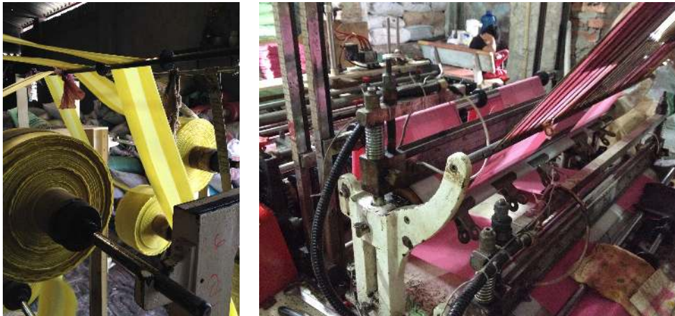
Les bobines de film plastique issu de l'extrudeuse de gonflage sont disposées sur un métier. Parfois, le film se froisse, bloquant totalement la machine. – Minh Khai - 2014
