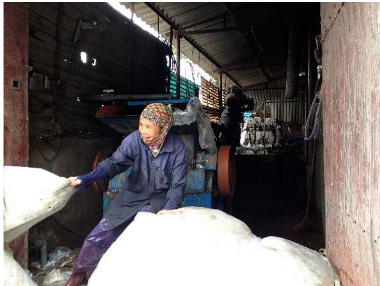
Cette ouvrière d'une soixantaine d'années tire des ballots de plastique usagés vers la broyeuse de la machine de recyclage (extrudeuse) qui décrasse et fond le plastique afin qu'il soit transformé en granulés. – 2014 - Như Quỳnh
