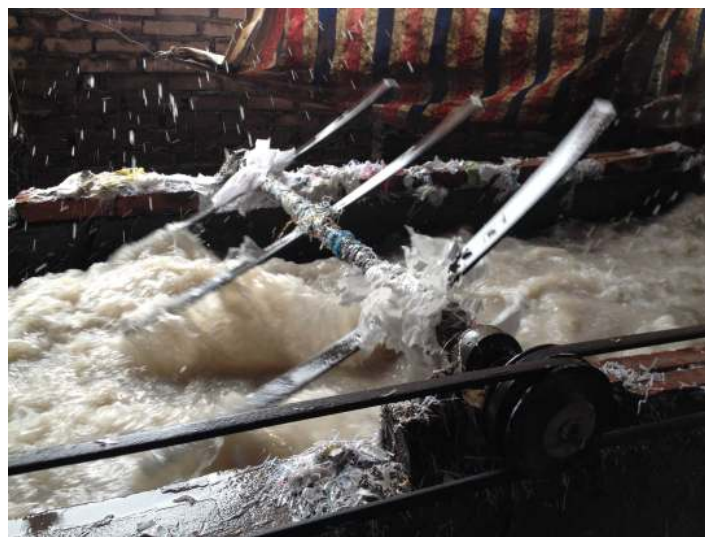
L'étape du bain de décrassage vise à nettoyer les films plastiques sales pour purifier le matériau avant transformation. – Minh Khai – 2014
