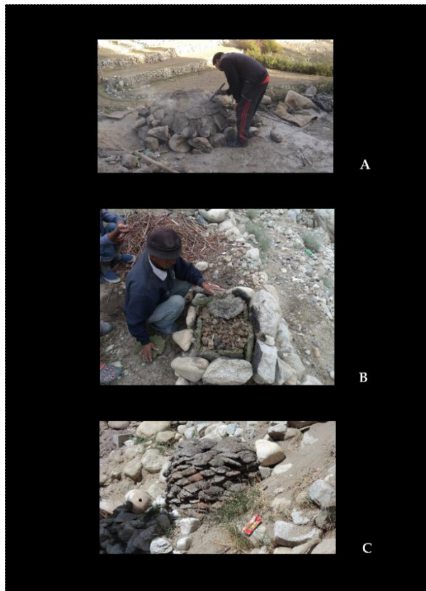
Figure 124 - Exemples de cuisson en aire ouverte à Likir, Ladakh : A - Cuisson en tas avec de la bouse de vache (Maison Ganajora) ; B - Cuisson ouverte avec de la bouse de vache et du crottin (Maison Apiso); C - Lieu de séchage et stockage de la bouse (maison Ganajora) (Photo : Broglia de Moura)
