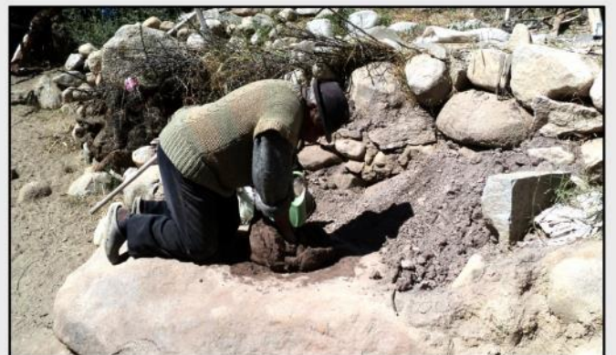
7. Pétrissage de la masse d'argile
