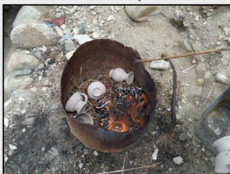
Processus de préchauffe des céramiques de la maison Apiso
