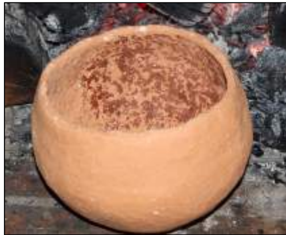
Figure 147 : La cire solide a été appliquée par frottement sur un pot à température ambiante. Le pot a ensuite été chauffé pour liquéfier le dépôt de cire.
