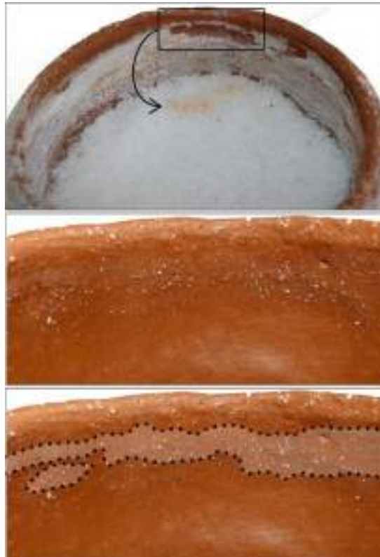
Figure 115 : Usure interne formée après six mois de stockage de sel (poterie polie à l'intérieur).
