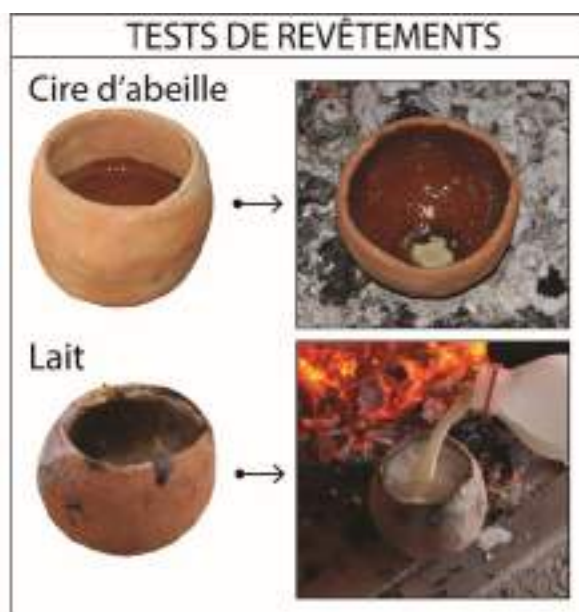
Figure 143 : Inventaire des revêtements utilisés pour les tests.
