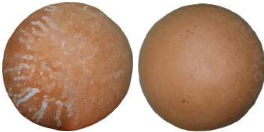
Figure 119 : Vue de la base de la poterie lissée à l'outil (à gauche) et de la poterie polie à l'extérieur (à droite) après le stockage de l'eau.
