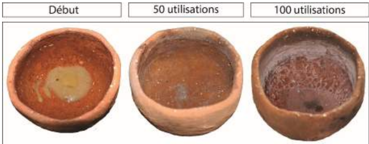
Figure 154 : Évolution de la poterie étanchéifier à la cire d'abeille après 100 ébullitions.
