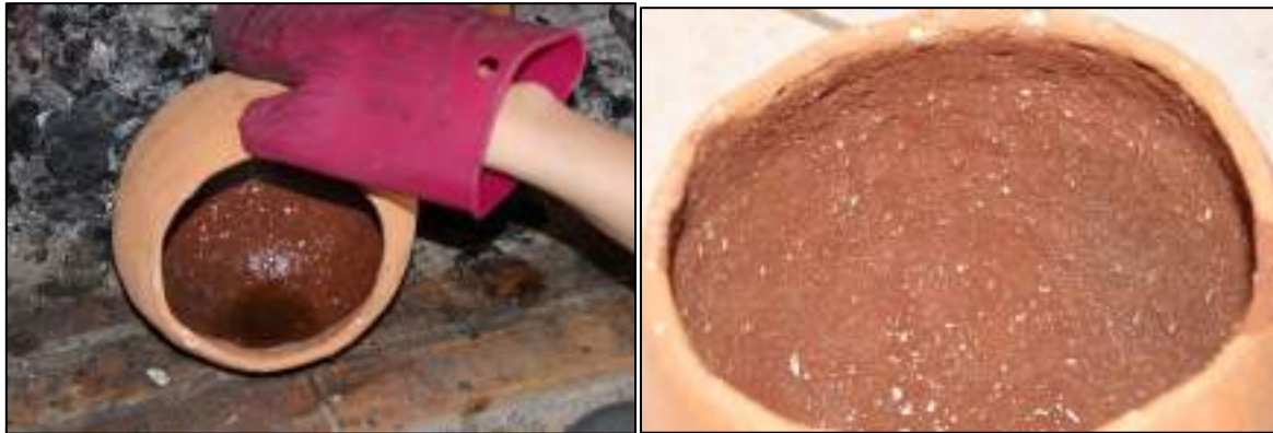
Figure 148 : Application de la cire sur pot chaud par rotations. Le résultat (à droite) est fin et homogène.
