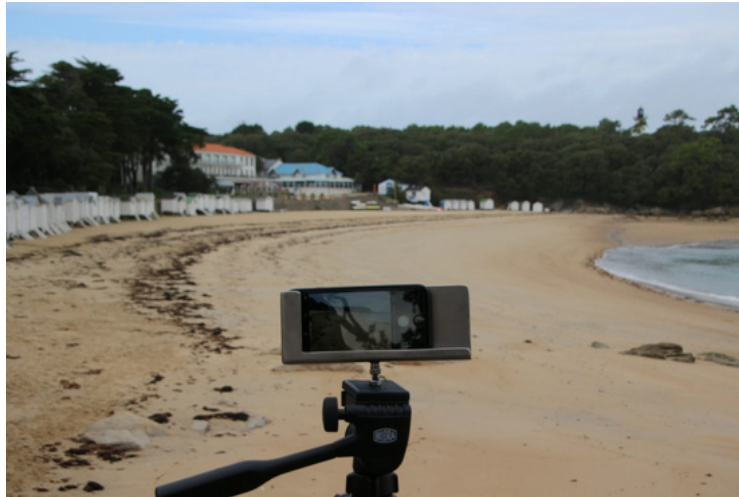
Figure 13 : Dispositif CoastSnap. Plage des Dames, commune de Noirmoutier-en-île (Source : OR2C)
