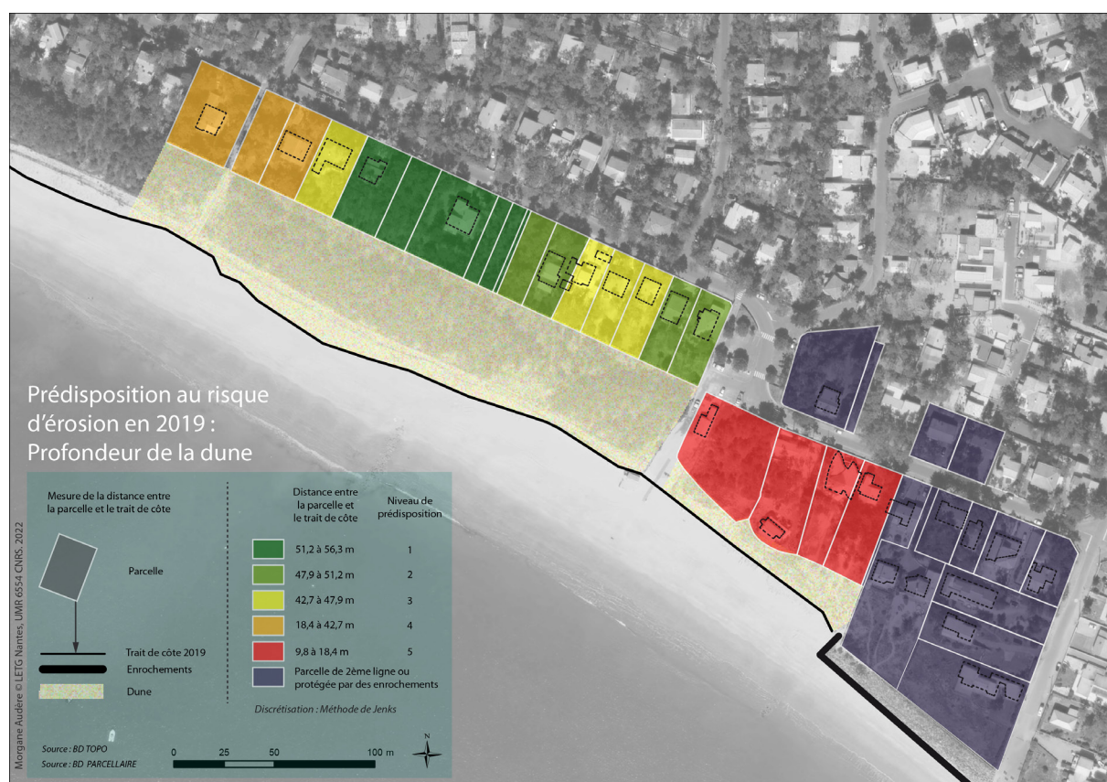
Figure 4 : Prédisposition de la parcelle au risque d'érosion en 2019 : Profondeur de la dune
