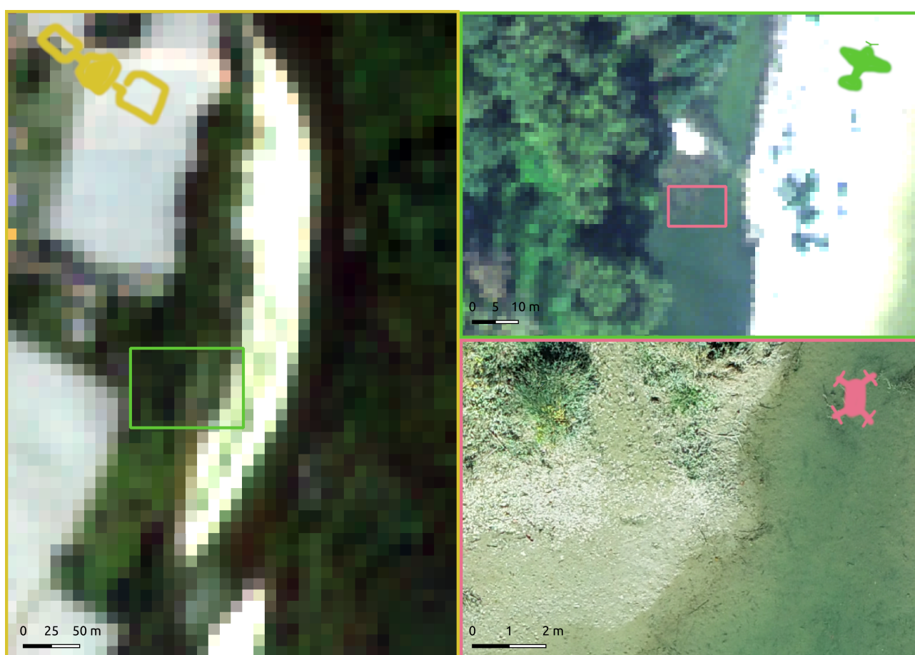
Figure 6: Composition colorée sur un secteur de l'Ain par satellite (jaune), avion (vert), et drone (rose). Chaque cadre coloré correspond à l'emprise spatiale de l'image suivante dans le changement d'échelle.
