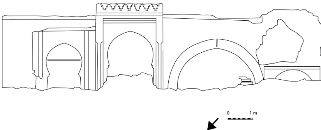
Fig. 1 : Relevé de l'élévation de la paroi Sud-ouest de la rawḍa d'Ibn 'Abbād (6/F/M) sur son versant intérieur. (© Bulle Tuil )
