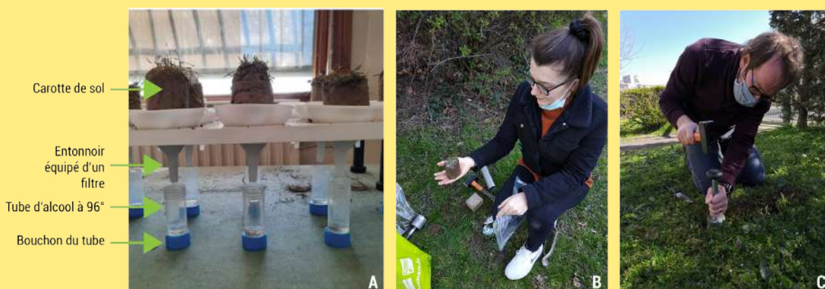
Figure 3.9. - Appareils de Berlèse (A) pour extraire la méso-faune issue des carottes de sols (B et C). Photos : C. Bréfort (A et B) et M. Bourgeois (C).
