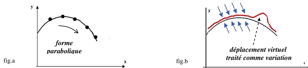
fig. a : ensemble des positions d'un objet en chute libre ; fig.b : variation possible de la trajectoire (en rouge) et la trajectoire optimale (en noir) quand variation entre les courbes a été minimisée.
