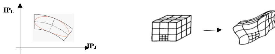
Le changement des limites sous l'effet d'une déformation quelconque
