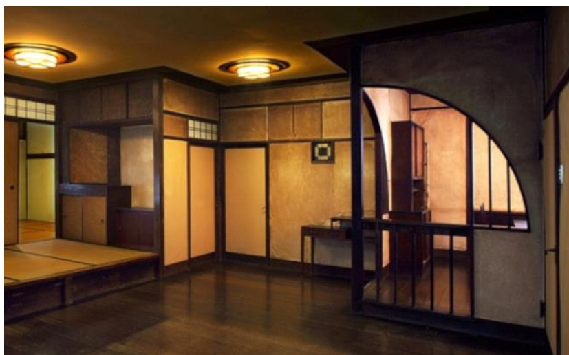
Figure 60. Vue d'intérieur de Chôchikukyo (1928) : Dans son salon, le sol du coin de trois tatamis est surélevé de 30 centimètres, afin d'ajuster la hauteur des yeux de ceux qui sont assis sur les chaises et sur les tatamis. © Takenaka kômuten 32
