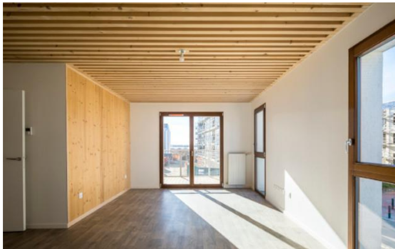
Figure 111. Le plafond de la dalle O'portune® de Woodyway (2020) : L'apparence du bois massif contribue grandement à la qualité du logement. Jean-Luc Sandoz considère comme important d'employer la structure en bois pour les logements sociaux en raison de sa propriété thermique, qui peut offrir un « confort organique ». © Sergio Grazia 69
