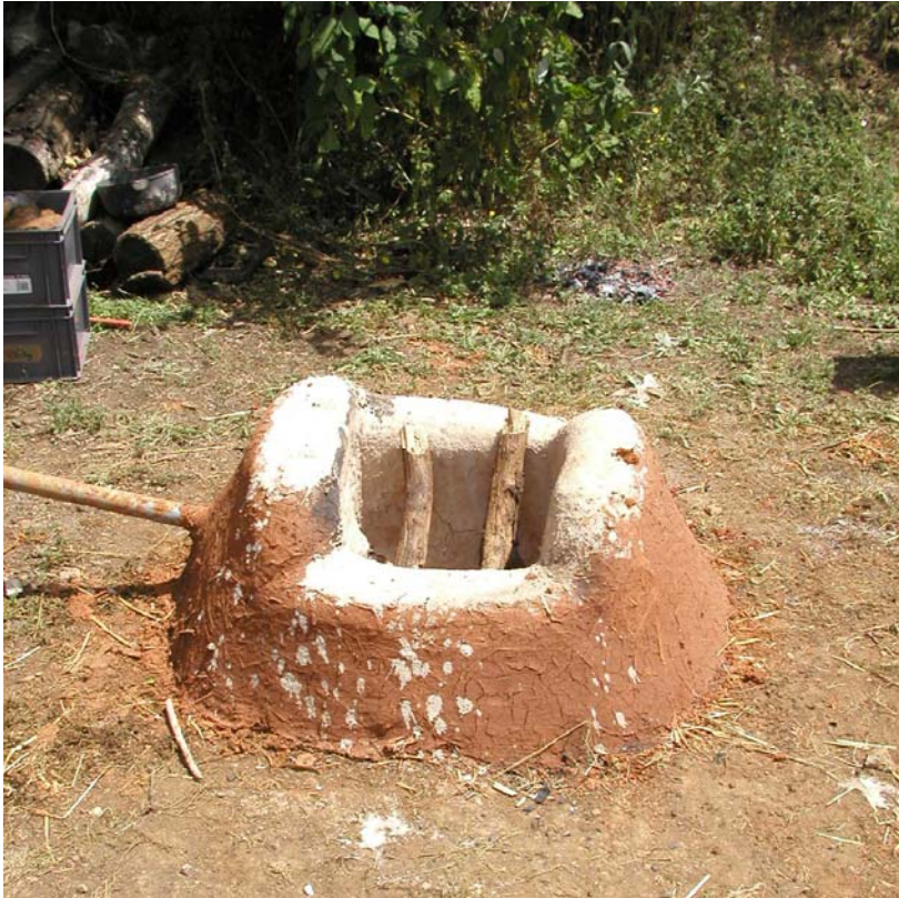
Figure 2 : foyer de forge utilisé pour le réchauffage de la loupe
