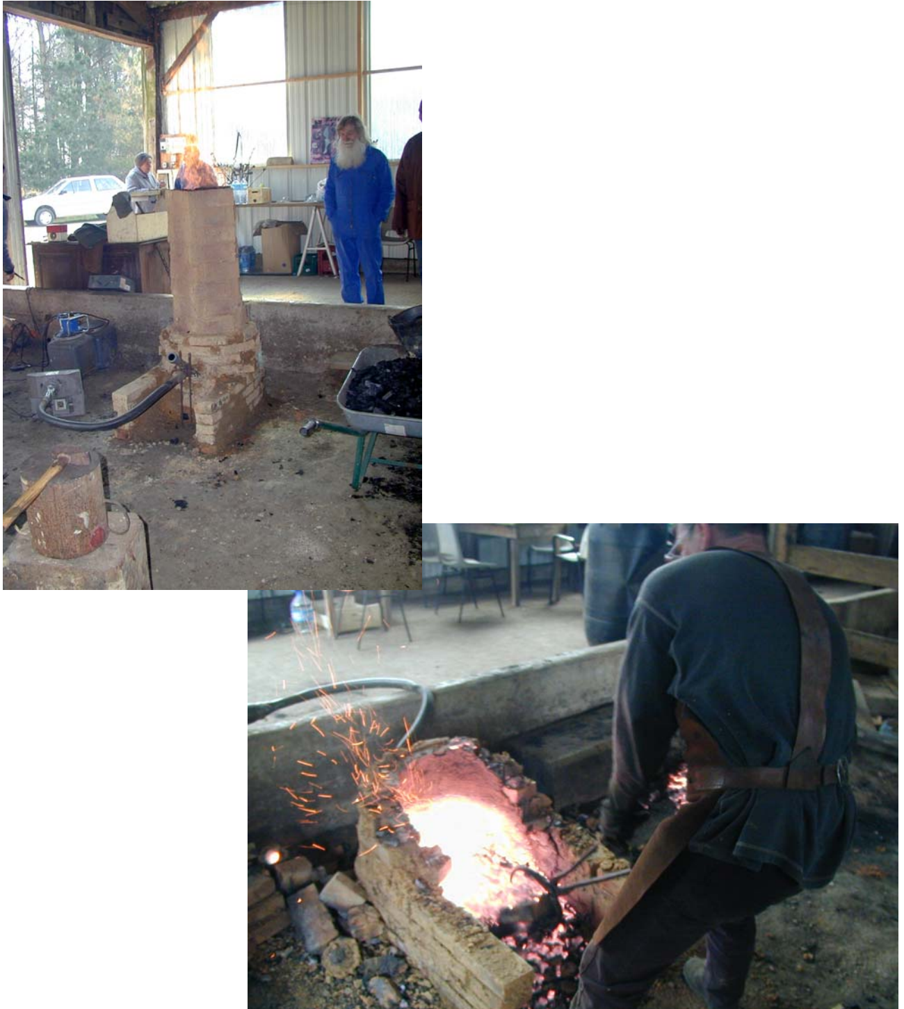
Figure 1 : Four de réduction et foyer d'épuration provenant de la destruction de ce four.
