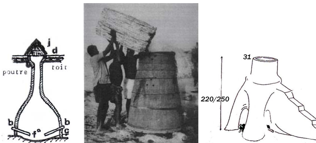
Fig. 19- Fours à convection et tuyères multiples africains. A gauche : Tuyères penchées vers le bas dans le procédé 'Bokoto' (Centrafrique). Source : Moniño, 1983, p. 290. Au centre : Tuyères horizontales dans le procédé Hausa (Niger). Source : Bernus, Echard, 1995, p. 76. A droite : tuyère penchées vers le haut et vers le bas sur un four minyânka (Mali). Source : Martinelli, 1993.
