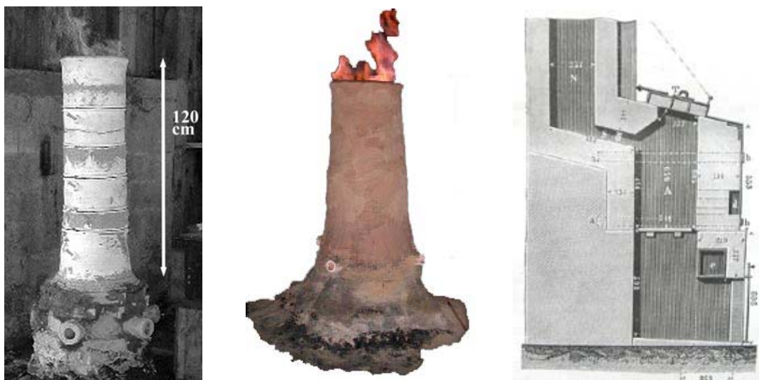
Fig. 18- A gauche : Expérimentations de C. Colliou, four de 30 cm de diamètre et four de 60 cm. Sources : Colliou, 2005 et Colliou, 2007. A droite : Four à essai à
