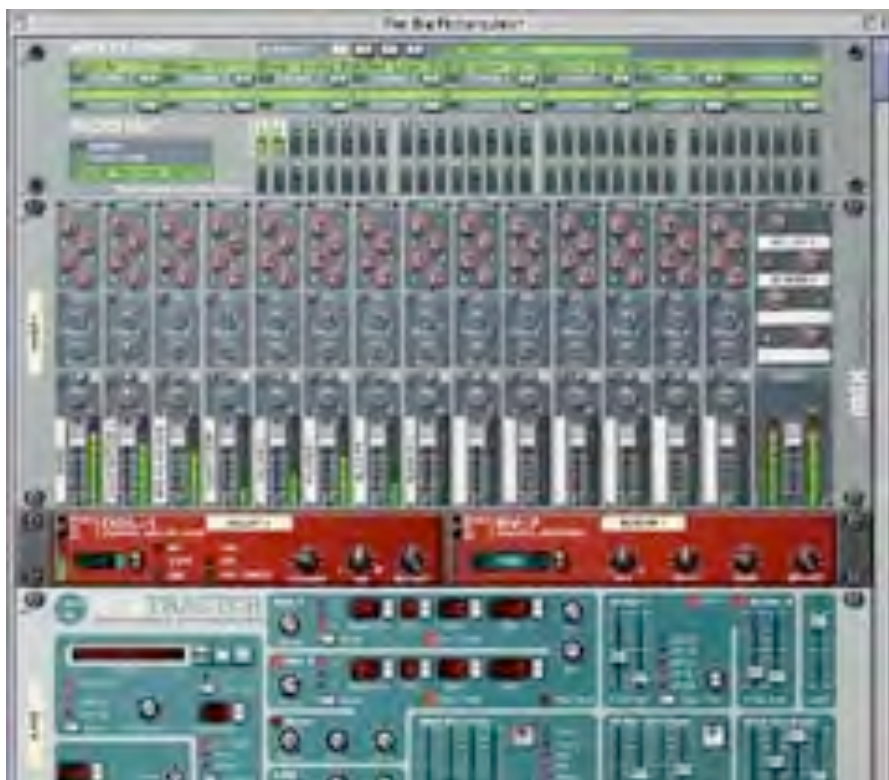
Figure 34 Le logiciel Reason dont l'ergonomie reproduit des outils de manipulation ou de traitement du son. Comme Live (utilisé par les technoïdes du panel), ce logiciel a comme caractéristique d'être composé d'éléments modulables que l'on relie par des câbles virtuels.
