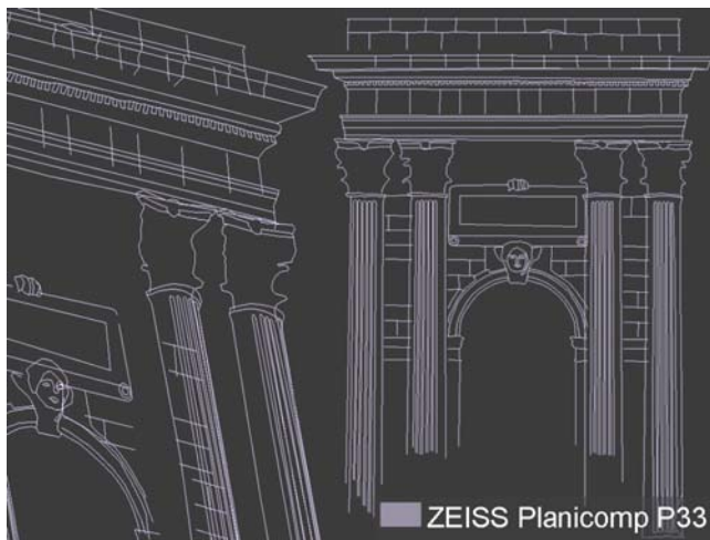
Figure 12 : modèle obtenu par restitution stéréoscopique (vue 3D et élévation)
