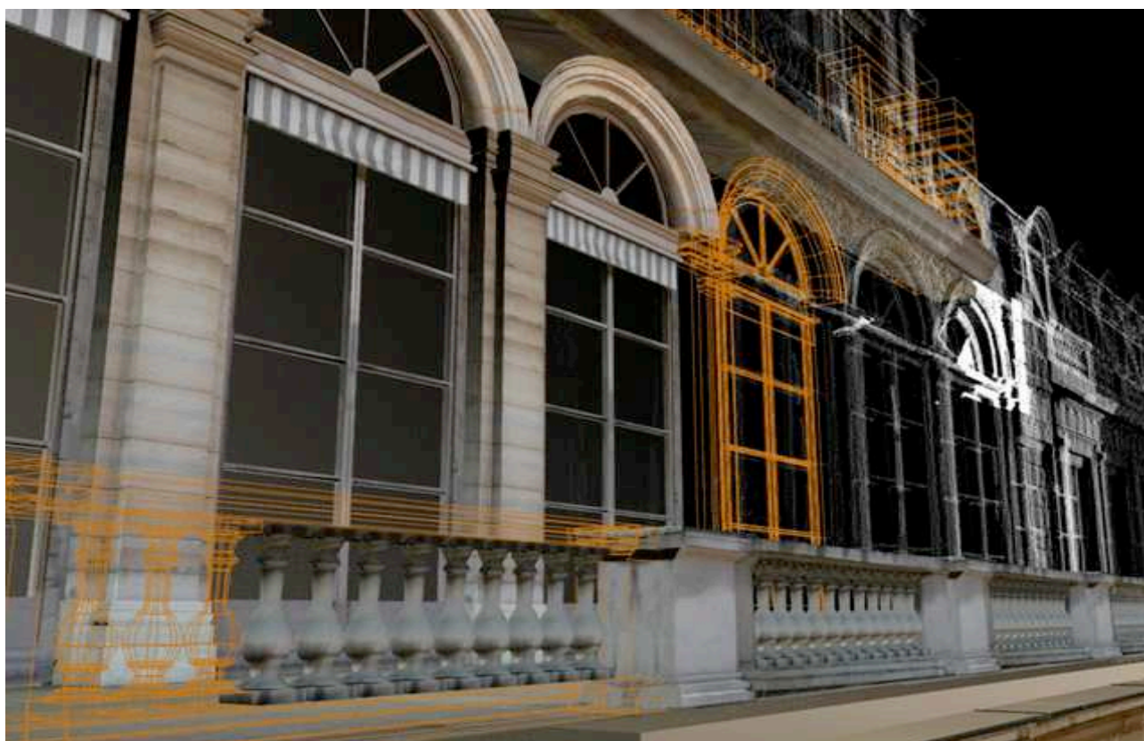
Fig.11. Résultat de la modélisation présentant le nuage de points, le modèle texturé et le modèle filaire
