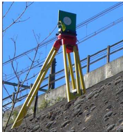
Abb. 7: Beispiel einer Zieltafel für den GX Scanner
