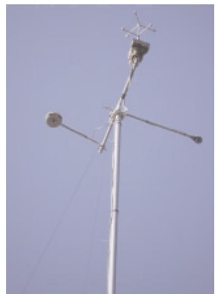
Figure 3 : Instruments de mesure installés au sommet d'un mât de 30 m.
