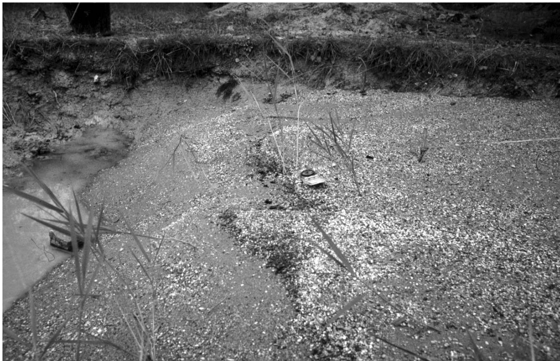
Fig. 10 - Vue du front de progradation du sédiment après les simulations d'intempéries. Noter la concentration en surface et au bas du front des gravillons, et le dernier état du front, en recul.
