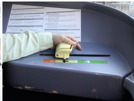
Manipulateur traction/freinage avec la commande de veille sur le Tramway Français Standard du réseau de la RATP.
