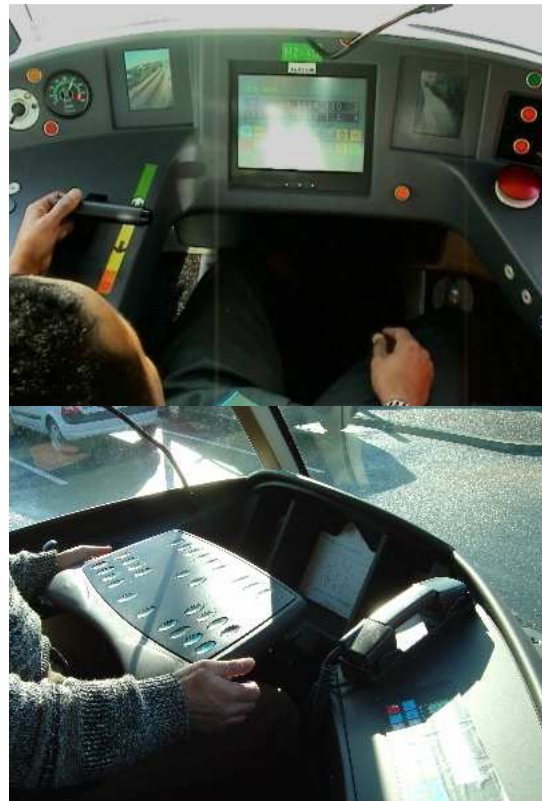
Poste de conduite du Citadis (T2) et maquette de celui du Translohr
