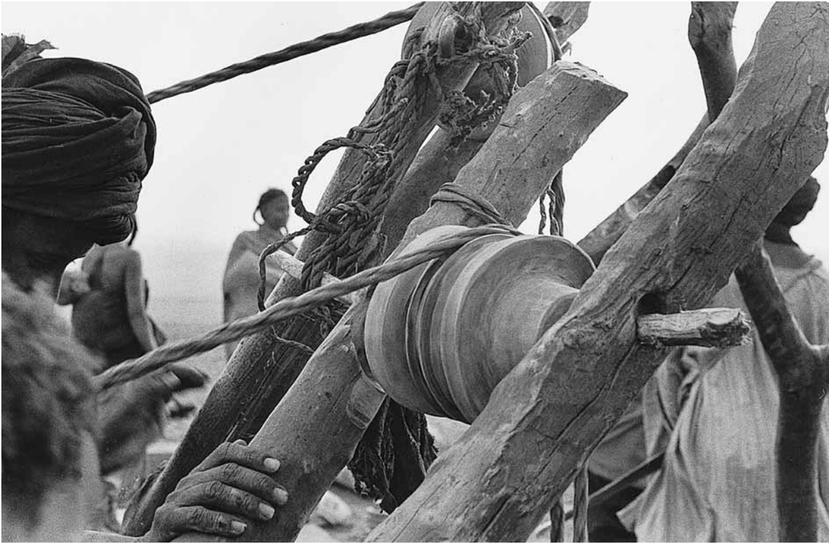
Poulie du puits
