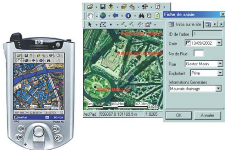
Figure 5. Le module ArcPAD permet de saisir des données in situ au moyen d'un assistant personnel
